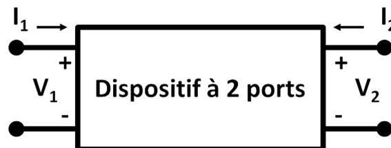
FIGURE III.1 – Représentation d'un quadripôle.
