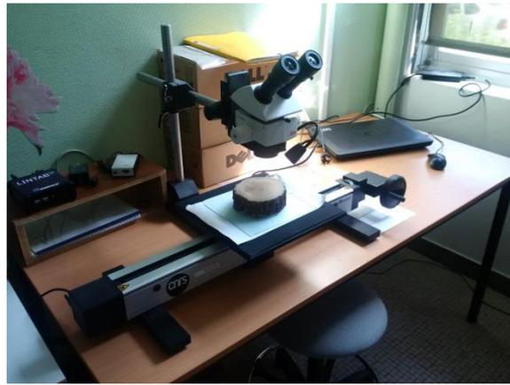
Figure II-59- Banc optique avec la loupe binoculaire.
