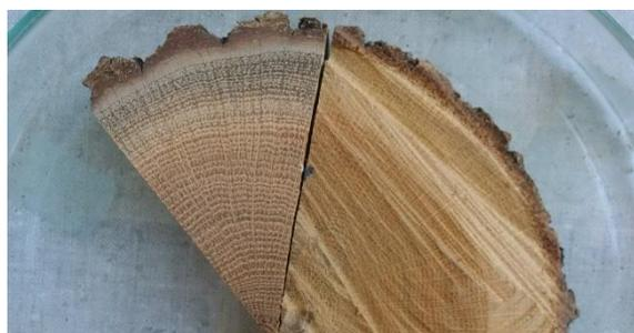
Figure II-58- Rondelle R après et avant polissage.
