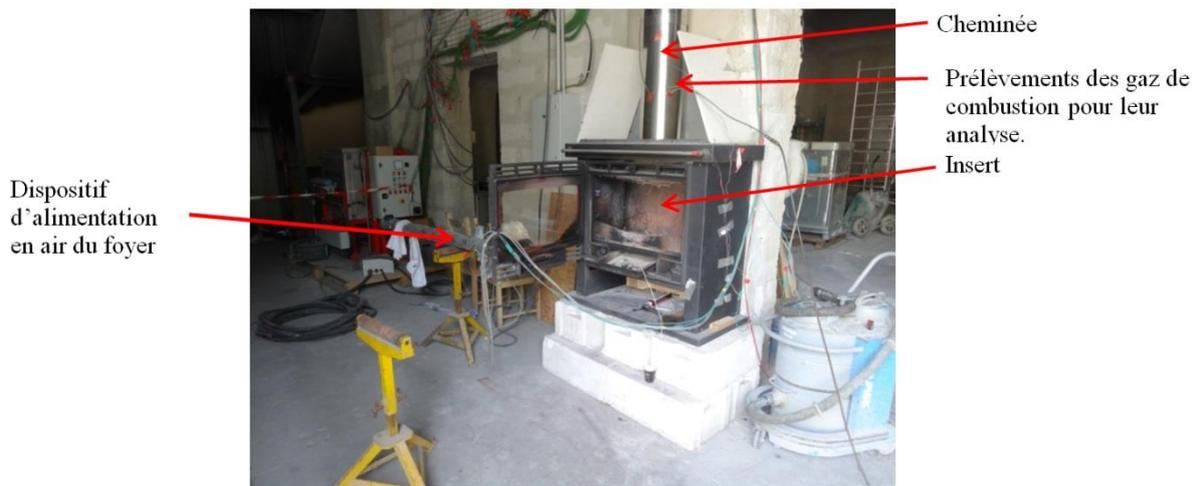
Figure II-46- Système de carbonisation expérimental installé au CSTB.
