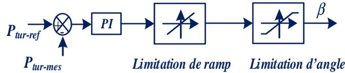
Figure 1.25 : Régulateur d'angle de calage des pales (zone III).
