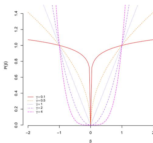
FIGURE 2.2 – Différentes pénalités Bridge en fonction de  $\gamma$
