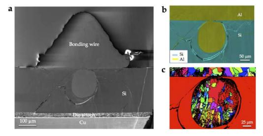
Figure 153: (a) Précipité quasi-millimétrique d'Al situé dans le substrat de Si dans un composant vieilli à défaillance. (b) Coupe FIB et cartographie EDX (Si bleu et Al-jaune). (c) Cartographie EBSD du précipité d'Al recristallisé dans le substrat. Chaque domaine de couleur correspond à une cristallite d'orientation distincte. Noter le domaine rouge au centre du grain, sans doute cristallisé en dernier.
