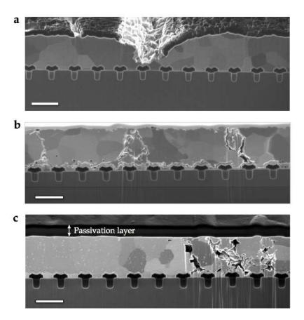
Figure 147: Fissuration de la métallisation développée dans une zone (a) non passivée, (b) passivée par mold compound et (c) passivé par  $SiO_2$  (plus mold compound). Barre d'échelle:  $2.5\mu m$ .
