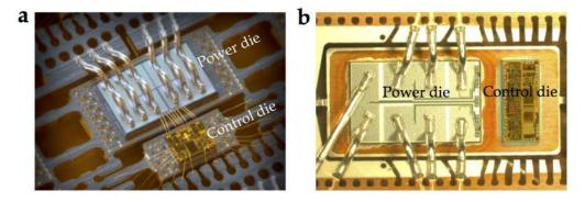
Figure 141: Composants de puissance de type LFET<sub>1</sub>T smart power MOSFET, produits par NXP Semiconductors. (a) 45V, 12V SPDo6, (b) 65V, 24V To<sub>7</sub>D1<sub>7</sub>.
