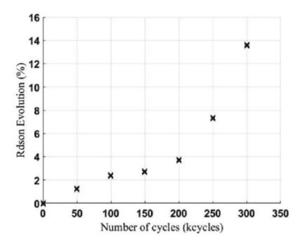
Figure 144: Evolution de  $R_{ds(on)}$  en cours de vieillissement, jusqu'à defaillance (après ~ 330kcycles).
