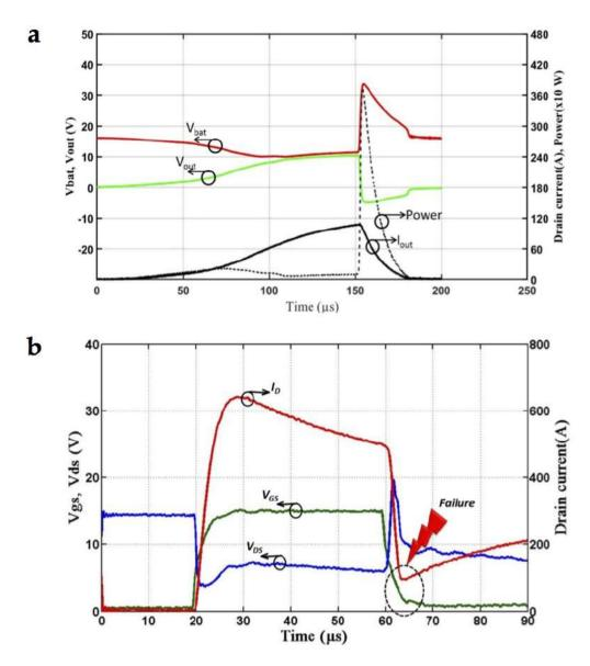
Figure 142: Formes d'onde au moment de la défaillance pour un composant (a) To7D17 soumis à des tests de qualification standard chez NXP et (b) SPD06 vieilli au sain du laboratoire SATIE par de test de court-circuit extrêmes.
