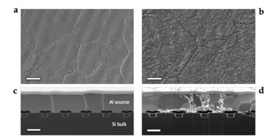
Figure 145: Évolution de la microstructure de la métallisation à base d'aluminium de SPDo6 pendant vieillissement à température ambiante. Les observations en surface (a) avant et (b) après vieillissement sont faites en SEM. Les coupes transverses (c) avant et (d) après vieillissement sont faite en FIB / SEM et les images sont faites par contraste ionique. Barre d'échelle:  $2.5\mu m$ .
