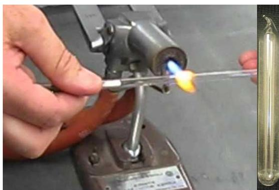
Figure II-1 : Photographie du processus de scellage d'un tube avec une photographie d'un tube scellé.
