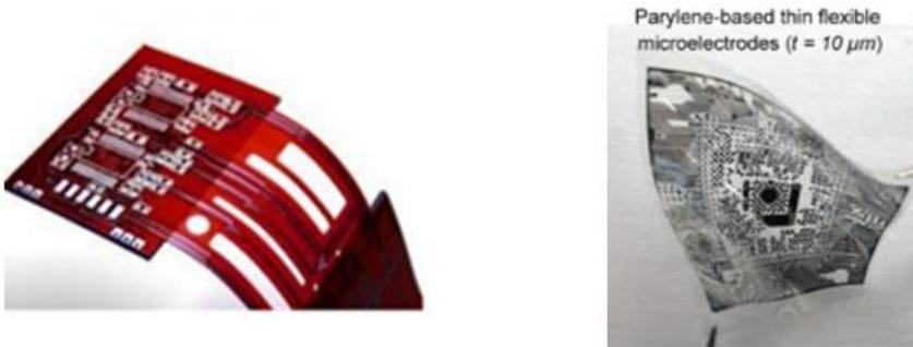
Figure I. 10 a) Câble Flexible PCB [[www.paryleneconformalcoating.com](http://www.paryleneconformalcoating.com)], b) microélectrode imprimée sur des films de parylène [Kim 17]
