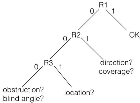
FIGURE 5: Arbre de décision binaire aidant au diagnostic de la source d'une défaillance.
