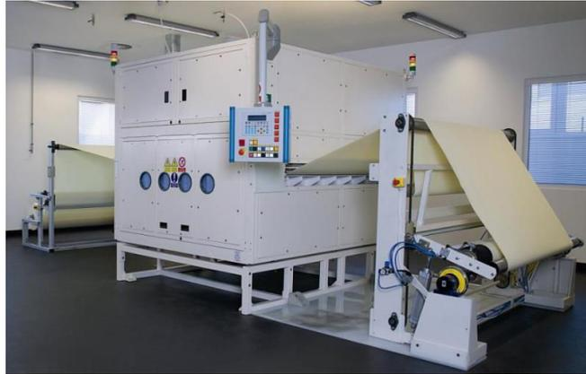
Figure 1-19 – Photo d'un procédé industriel d'électrospinning Nanospider™
