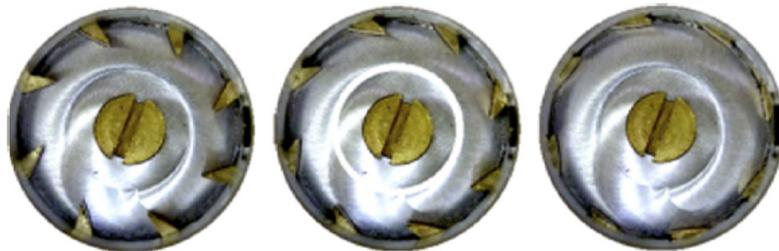
**FIGURE 2.9** – Swirler radial à angle de pales variable. Trois positions sont représentées. Image reproduite de *Durox et al. (2013)*
