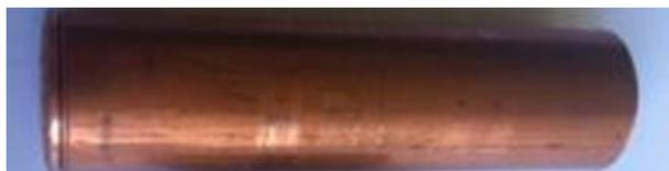
Figure 110 - Exemple de tube en cuivre (longueur ~10 cm) utilisé pour les synthèses de poudre
