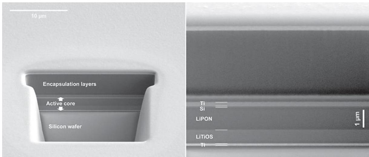
Figure 19 - Cliché MEB d'une coupe FIB d'une microbatterie LiTiOS/LiPON/Si
