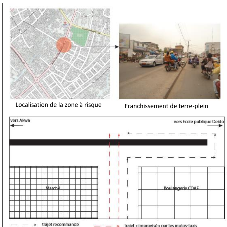
Figure 42 : Franchissement dangereux de terre-plein à Deïdo
