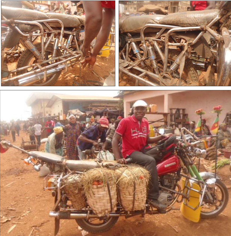
Photo 32: Une moto-brousse renforcée © Kalieu 2015
