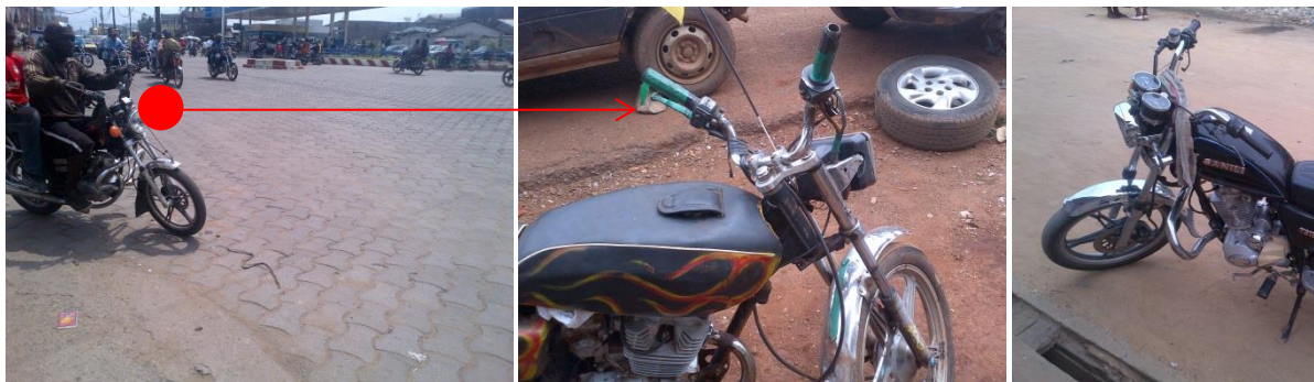
Photo 36 : Moto-taxi à guidon tordu. Notons la déformation par rapport à un guidon original © Kalieu 2015
