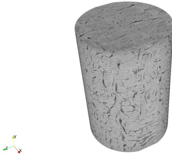
FIGURE 1.3 – Tomographie d’un échantillon de Carbone/Carbone avec les axes d’orientation
