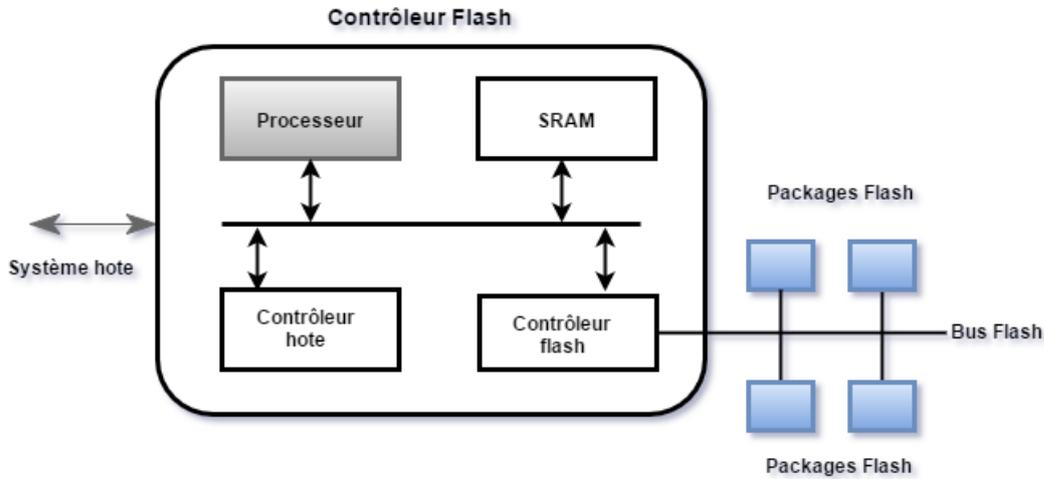
FIGURE 2.13 – Architecture d'un disque SSD
