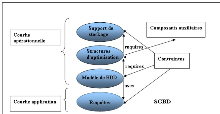
FIGURE 3.2 – Couches à prendre en charge par un modèle de coût
