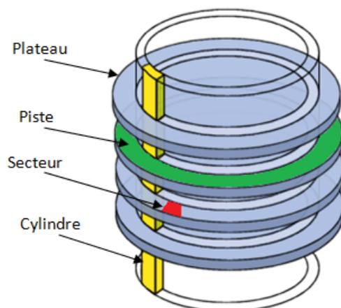
FIGURE 2.11 – Structure physique des disques durs
