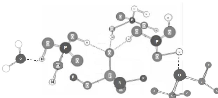
Figure III-15 : Vue hypothétique du complexe TBP.(H<sub>3</sub>PO<sub>4</sub>)<sub>n</sub> avec n= 2, 3, 4 solvato par le DiPE.
