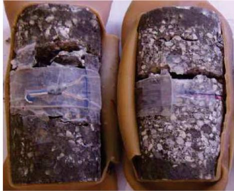
FIGURE 1.9 – Faciès de rupture. Essai triaxial à un confinement de 650MPa (à gauche) et 200MPa (à droite) [26]
