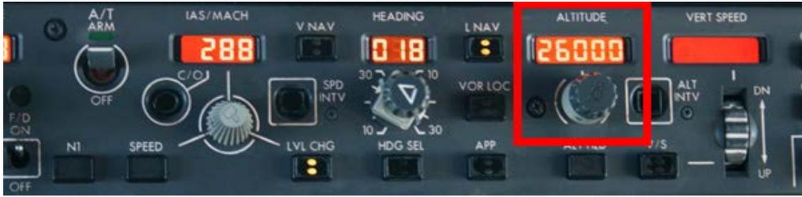
FIGURE 2.1: Bouton rotatif de capture d'altitude
