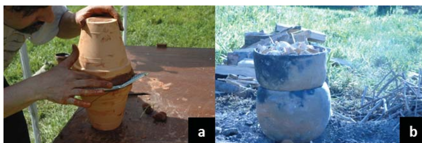
Fig. 62. Les deux procédés en double pot utilisés (a = procédé à « pot supérieur renversé » luté avec de l'argile ; b = procédé à « pot supérieur perforé » rempli de copeaux d'écorce).
