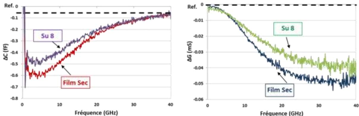
Figure III. 4 Spectres des contrastes  $\Delta C$  (gauche) et  $\Delta G$  (droite) moyennés pour cellule vivante dans des composants réalisés en technologies film sec DF et SU-8
