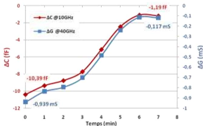
Figure III. 22 Variation des contrastes  $\Delta C$  et  $\Delta G$  en fonction du temps de la concentration éthanol à 30 % pendant 7min
