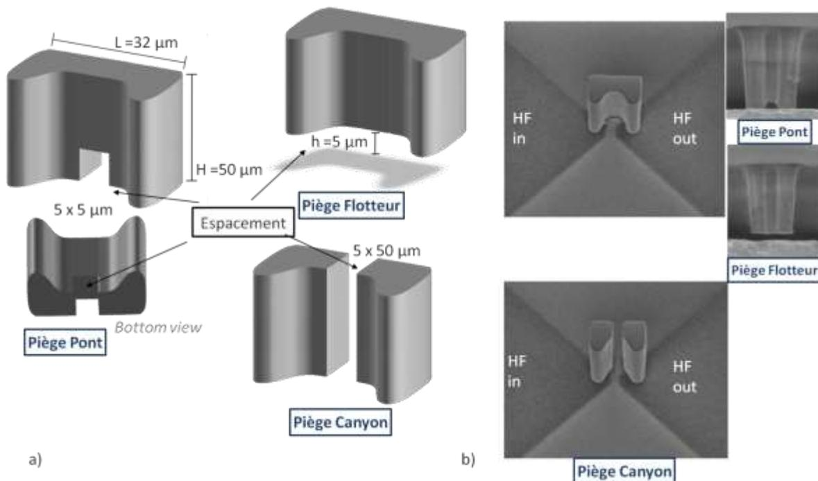
Figure II. 18 (a) Images 3D et (b) Images MEB des trois modèles de pièges mécaniques
