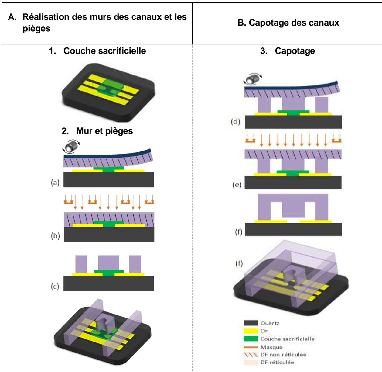
Figure II. 16 Procédé de fabrication en technologie DF-1000
