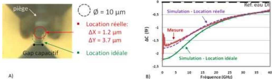
Figure III. 5 Impact de la position de la particule : (a) position réelle et idéale, (b) contrastes capacitifs des résultats de simulation et mesure
