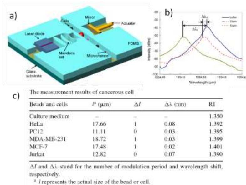
Figure I. 15 Système de caractérisation de cellules uniques cancéreuses par la mesure de RI (reproduit de [51])
