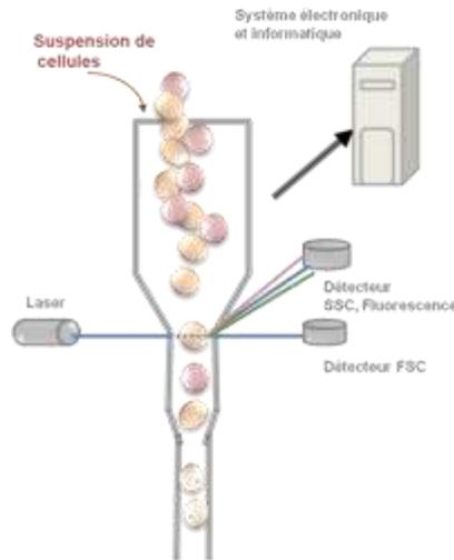
Figure I. 8 Représentation schématique d'un cytomètre de flux
