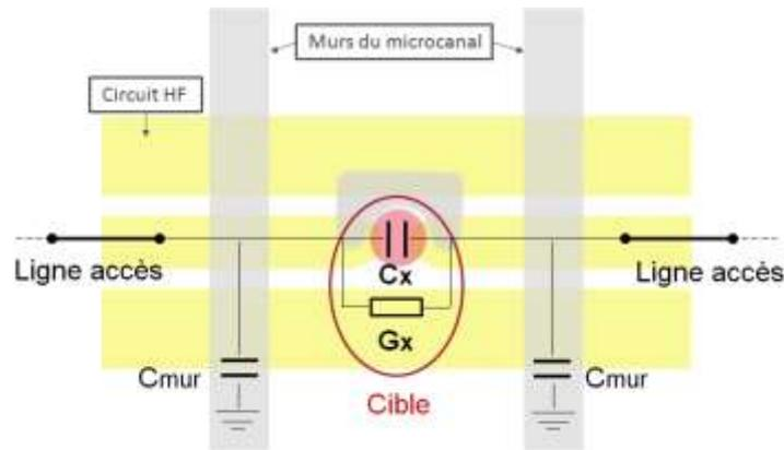
Figure II. 5 Schéma électrique équivalent du biocapteur
