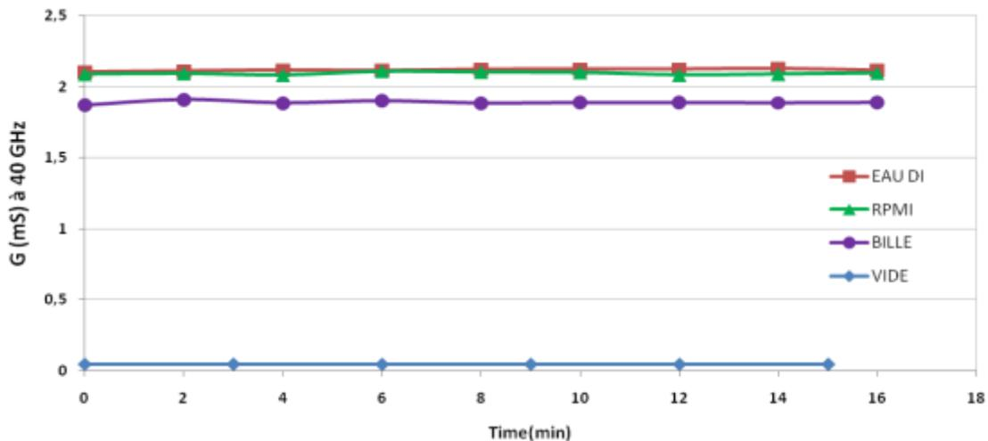
Figure III. 26 Valeurs de conductance à 40 GHz du suivi en temps lorsque le microcanal est rempli d'air (vide), d'eau DI, de milieu RPMI et avec une bille de diamètre de 10  $\mu\text{m}$  dans du milieu RPMI
