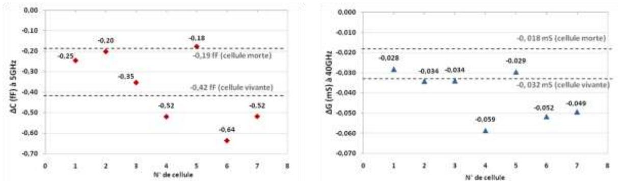
Figure III. 19 Résumé des contrastes  $\Delta C$  (gauche) et  $\Delta G$  (droite) à 5 et 40 GHz respectivement des cellules traitées avec DMSO à 10%
