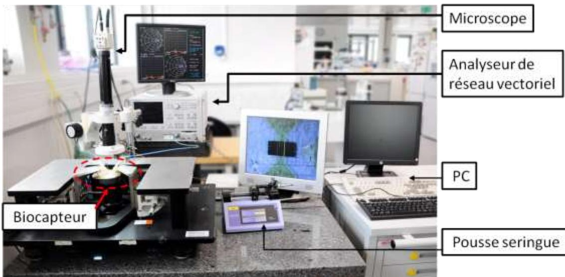
Figure II. 4 Banc de test biocapteur microfluidique
