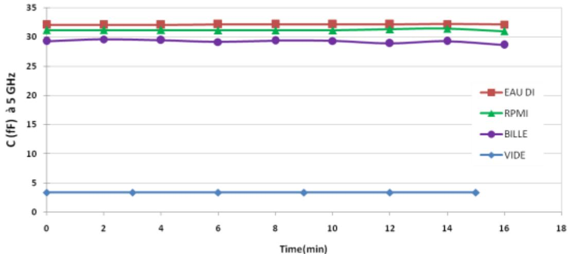
Figure III. 25 Valeurs de capacité 5 GHz du suivi en temps lorsque le microcanal est rempli d'air (vide), d'eau DI, de milieu RPMI et avec une bille de diamètre de 10  $\mu\text{m}$  dans du milieu RPMI
