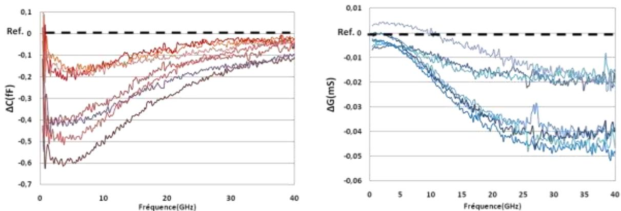
Figure III. 13 Spectres des contrastes  $\Delta C$  (gauche) et  $\Delta G$  (droite) des cellules traitées 50°C pendant 30min
