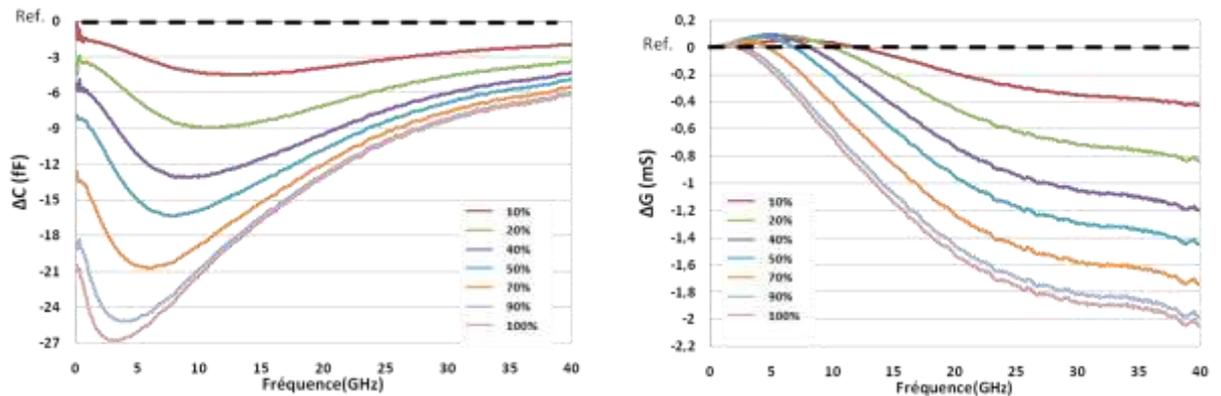
Figure II. 11 Spectres des contrastes capacitif et conductif des mesures de mélange éthanol/eau : 100% - 10 %
