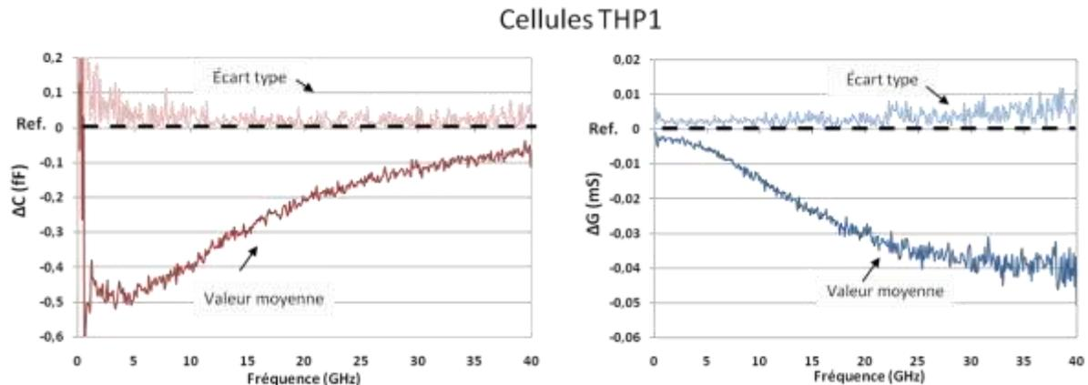
Figure III. 3 Spectres des contrastes  $\Delta C$  (gauche) et  $\Delta G$  (droite) moyennés et les écart-types correspondants de six mesures des cellules THP1 vivantes, directement dans leur milieu de culture RPMI
