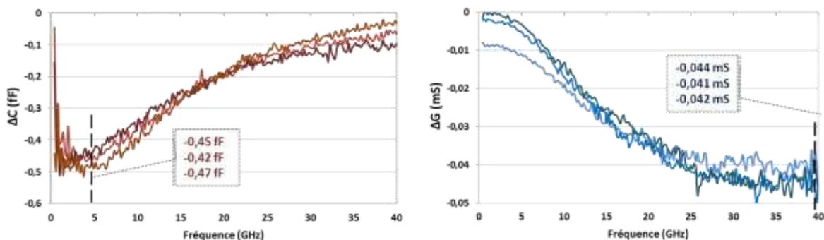
Figure III. 6 Spectres des contrastes  $\Delta C$  (gauche) et  $\Delta G$  (droite) moyennés pour cellule vivante dans des différents composants réalisés en technologies SU-8 et à différents jours.
