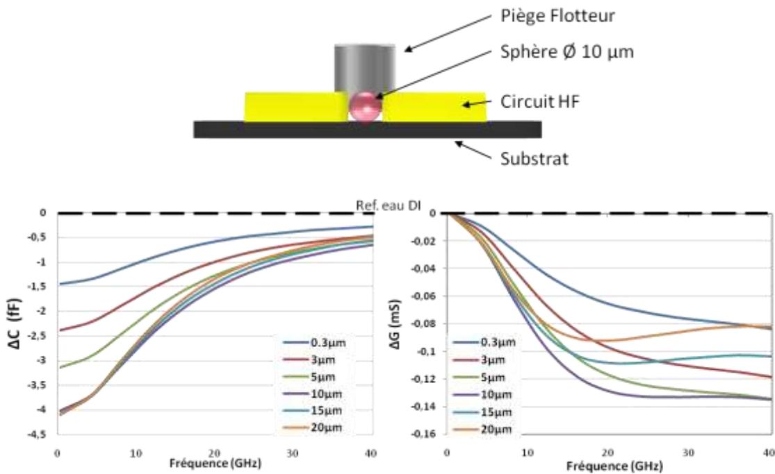
Figure II. 32 Spectres des contrastes  $\Delta C$  et  $\Delta G$  d'une bille de polystyrène de diamètre de 10  $\mu\text{m}$  pour les épaisseurs de métallisation d'or comprises entre 0,3  $\mu\text{m}$  et 20  $\mu\text{m}$
