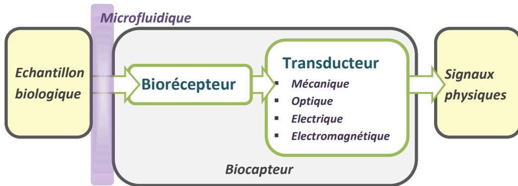
Figure I. 11 Représentation systémique d'un biocapteur
