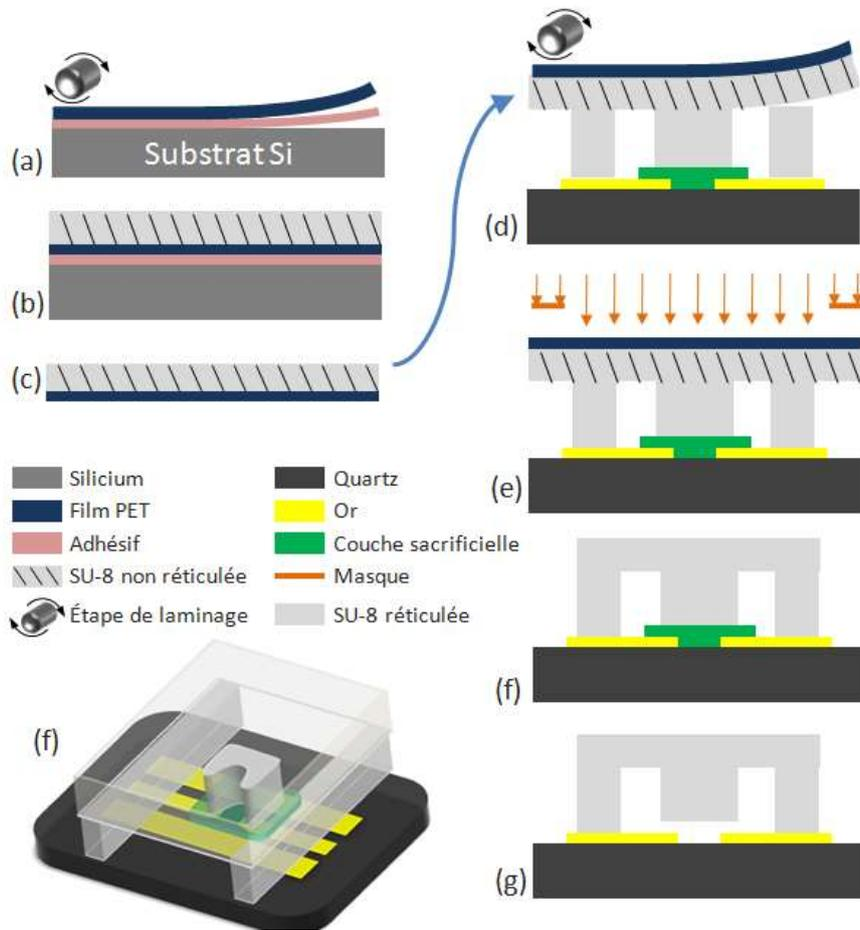
Figure II. 15 Procédés de fabrication en technologie SU-8 : (b) Capotage des canaux
