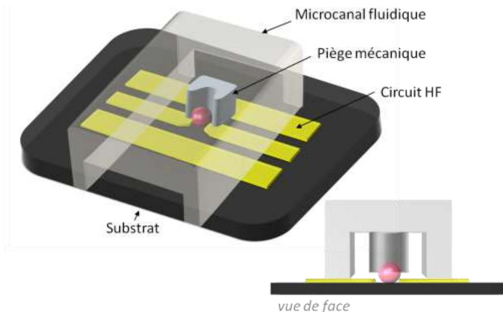
Figure II. 1 Schémas 3D du biocapteur micro-onde à cellule unique avec une particule piégée (représentée par la bille rouge)
