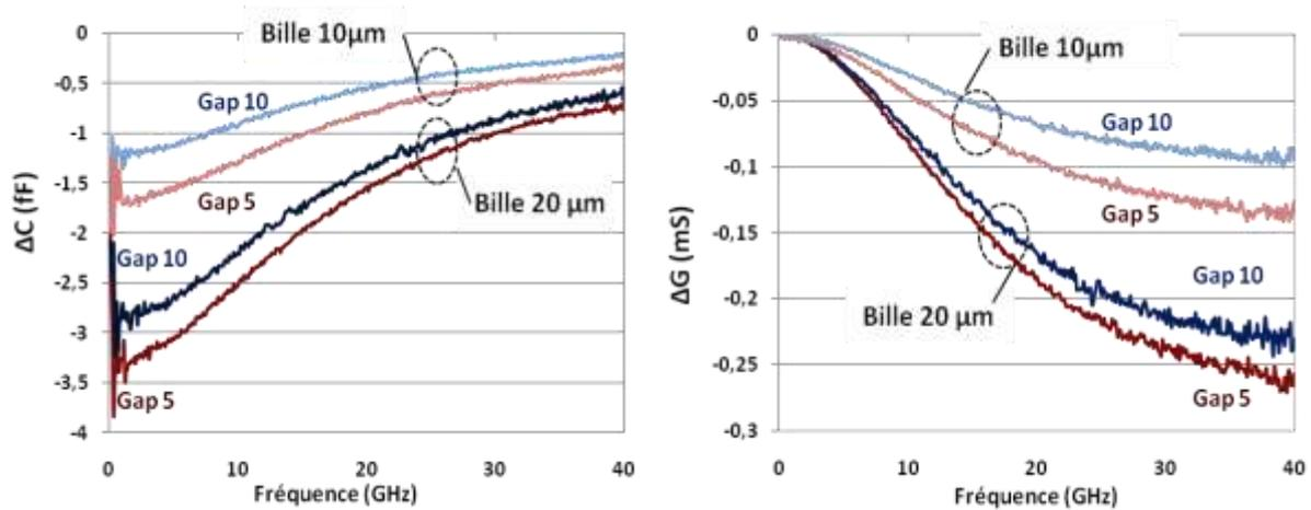
Figure II. 31 Spectres des contrastes  $\Delta C$  et  $\Delta G$  mesurés des billes de diamètre 10 et 20  $\mu\text{m}$  dans de l'eau DI, avec les biocapteurs muni un Piège Flotteur ayant un gap capacitif de 5 et 10  $\mu\text{m}$
