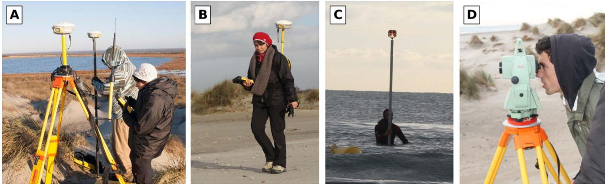
FIGURE 3.7 – Appareils de mesure topo-bathymétrique : (A) station de base du DGPS RTK Trimble et canne, (E) lever DGPS au sac à dos, (C) mire et (D) station totale LEICA TCR805.
