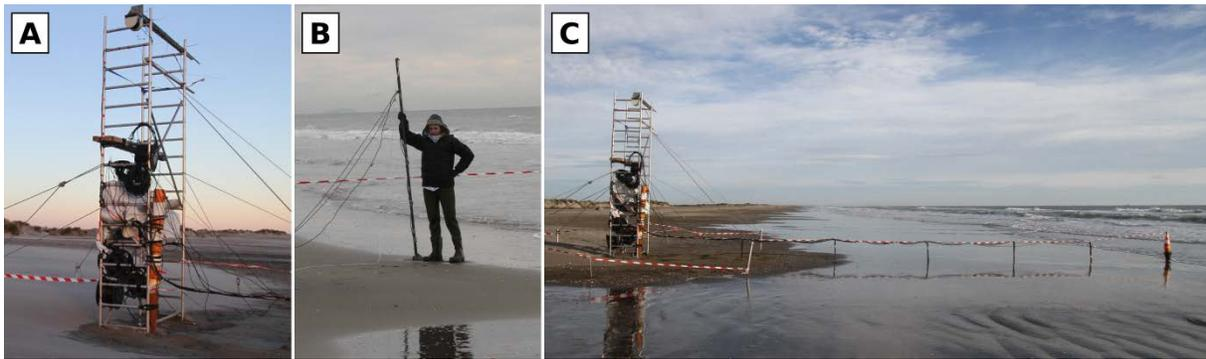
FIGURE 3.13 – Appareils de mesures haute-fréquence : (A) LiDAR monté sur l'échafaudage, (B) capteurs de pression câblés montés sur une cornière avant enfouissement et (C) vue générale du déploiement haute-fréquence.
