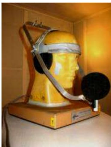
Figure 6-2 : Monture de fixation réalisée pour des microphones B&K
