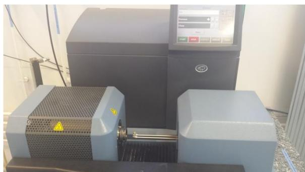
**Figure 2.3. Analyseur TGA de type SQT Q600.**
