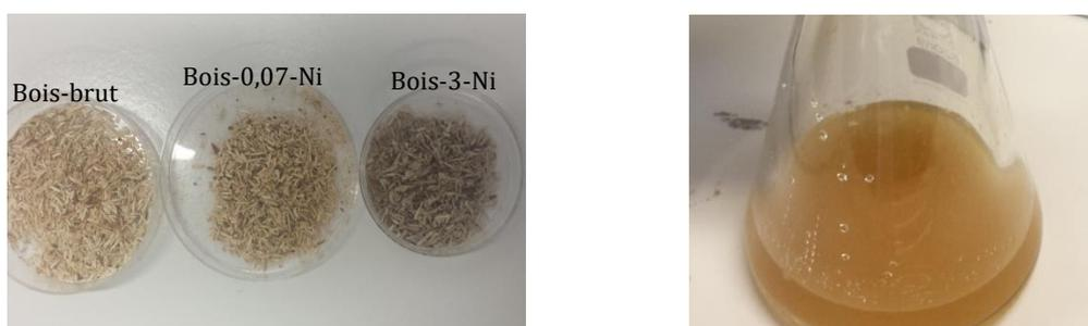
**Figure 2.8. Coloration brune des échantillons du bois et de la solution après imprégnation.**
