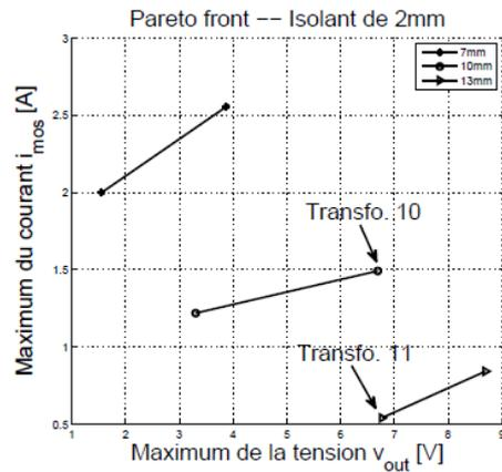
b. PCB Insulation layer 2 mm
