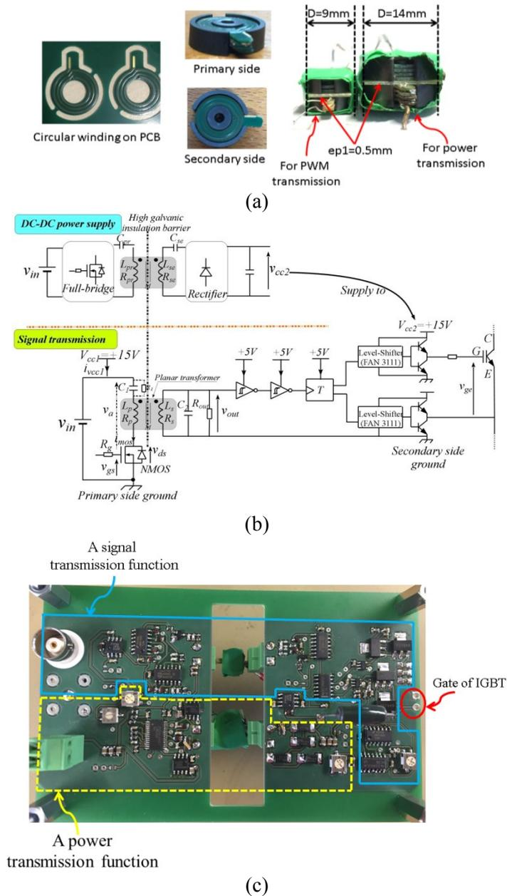
Fig. 8: Prototype des transformateurs et des fonctions étudiées
