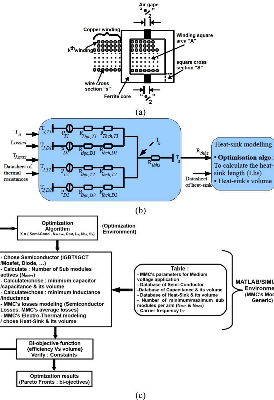
Fig. 2: Outil de pré-dimensionnement de convertisseurs MMC
