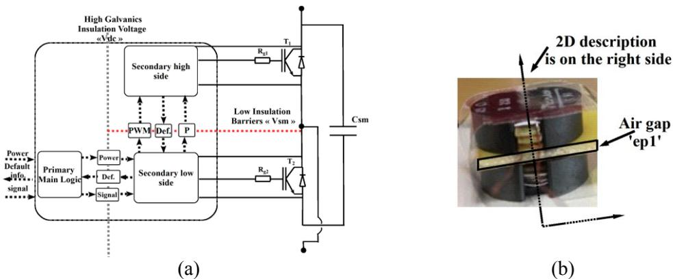
Fig. 4: Nouvelle architecture de commande rapprochées pour bras d'onduleur (ou submodule MMC).
