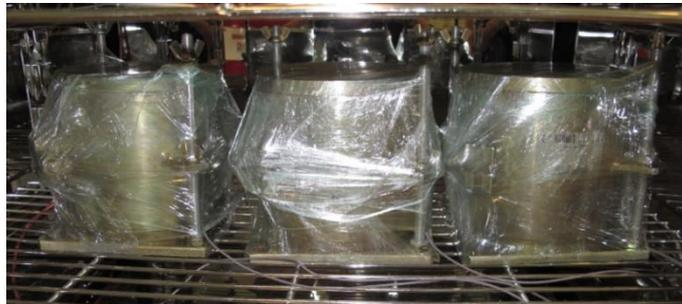
Figure 3. 1 : Eprouvettes isolées et placées dans l'enceinte climatique.
