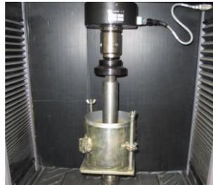
Figure 2. 8 : Essai de poinçonnement.
