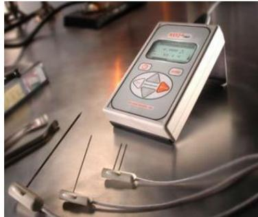
Figure 2. 17 : KD2 Pro avec les sondes thermiques.
