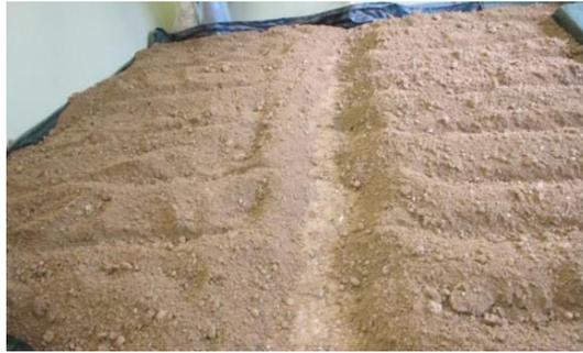
**Figure 2. 1 : Séchage naturel du matériau.**
