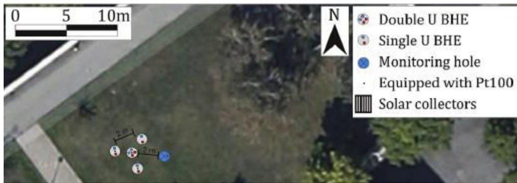
Figure 1. 21 : Schéma d'implantation des sondes thermiques (Giordano et al. 2016).
