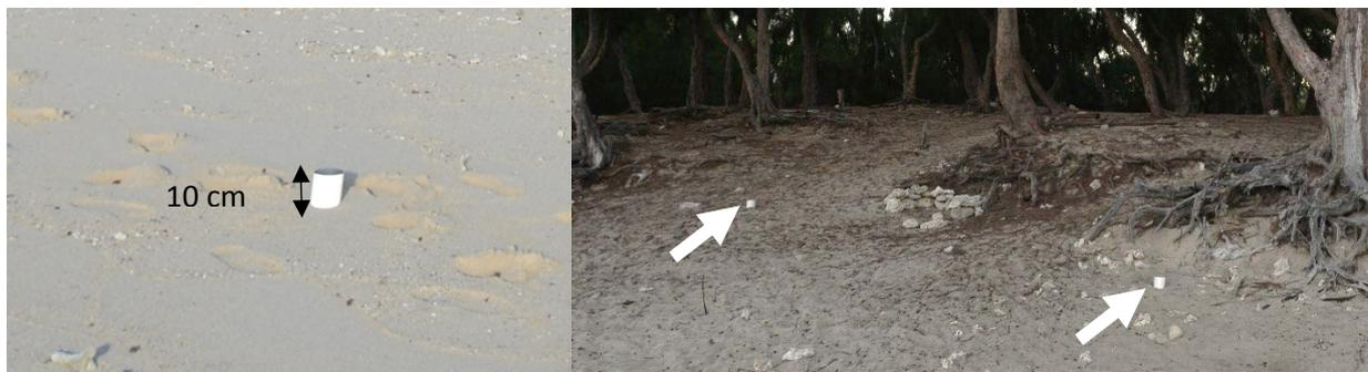
Figure 4-8: Cibles réfléchissantes cylindriques utilisées pour les acquisitions TLS
