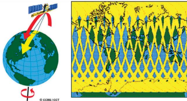
**Figure 18 : Balayage de la surface du globe par un satellite héliosynchrone (Source : Tutoriel du [Centre Canadien de Télédétection](#))**
