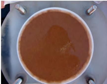
**Figure 5 : Exemple de filtre d'un prélèvement effectué à 16,5 m de profondeur. La quantité d'eau filtrée correspond à 660ml.**
