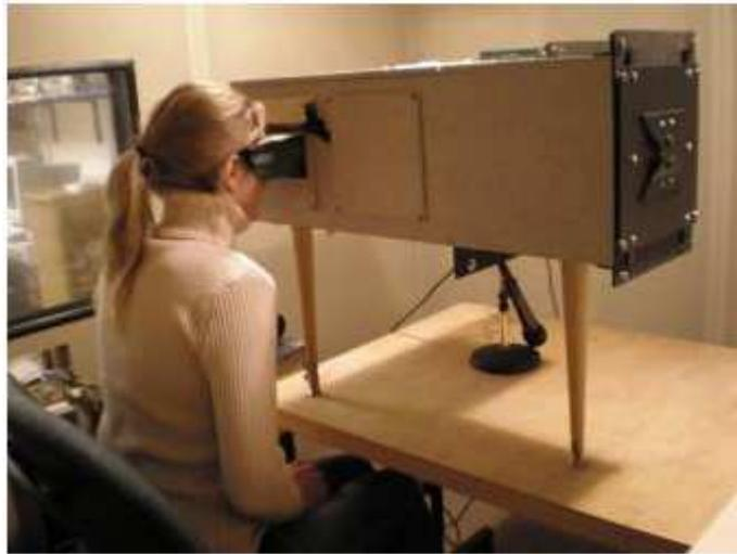
Participante au tachistoscope. Les cartes comportant des stimuli sont éclairées individuellement par des tubes sur le côté. Le temps et le séquençage sont contrôlés par ordinateur.
