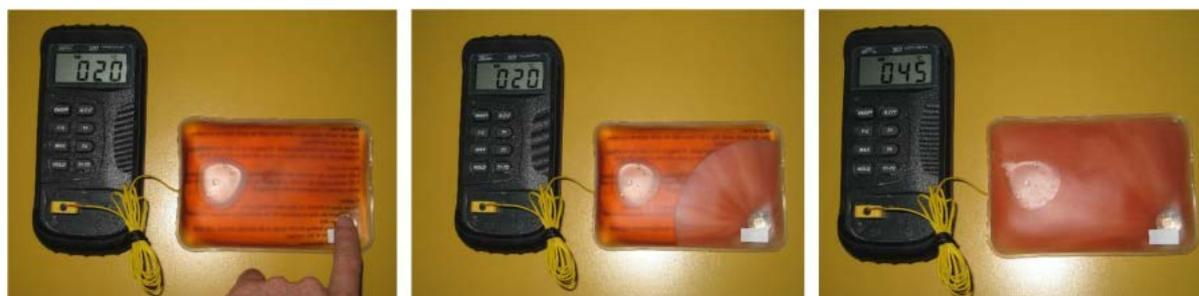
FIGURE 1.9 – Solidification forcée d'une poche de MCP en surfusion.
