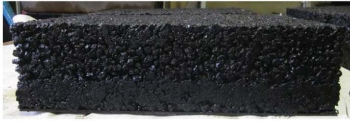
**Figure 2.30:** Prototype tricouche avec couche intermédiaire bitumineuse [89]
