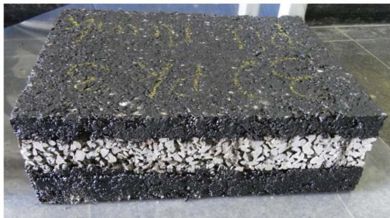
**Figure 2.29:** Prototype tricouche avec couche intermédiaire au liant en polyuréthane [89]
