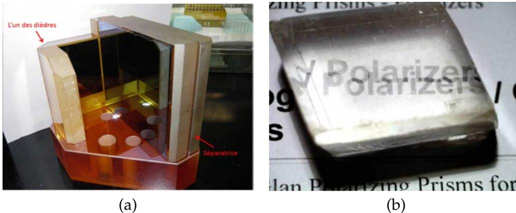
FIGURE 1.2: (a) Séparatrice en ZnSe de l'instrument Sieleters développé à l'ONERA. On y voit aussi un des deux dièdres (COUDRAIN et al., 2015). (b) Illustration du phénomène de double réfraction dans les milieux biréfringents (UNIVERSITÉ DU MAINE, 2016).
