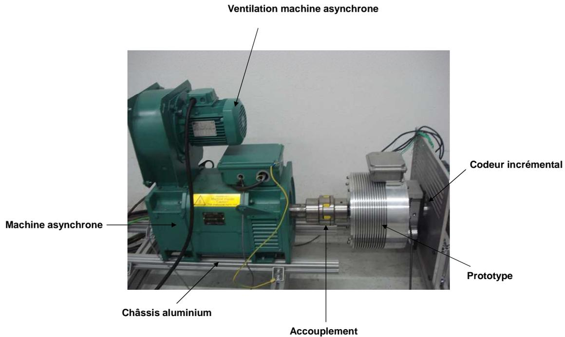
Figure 75 : Banc d'essais
