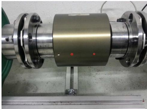
Figure 79 : Ensemble accouplement / capteur couple
