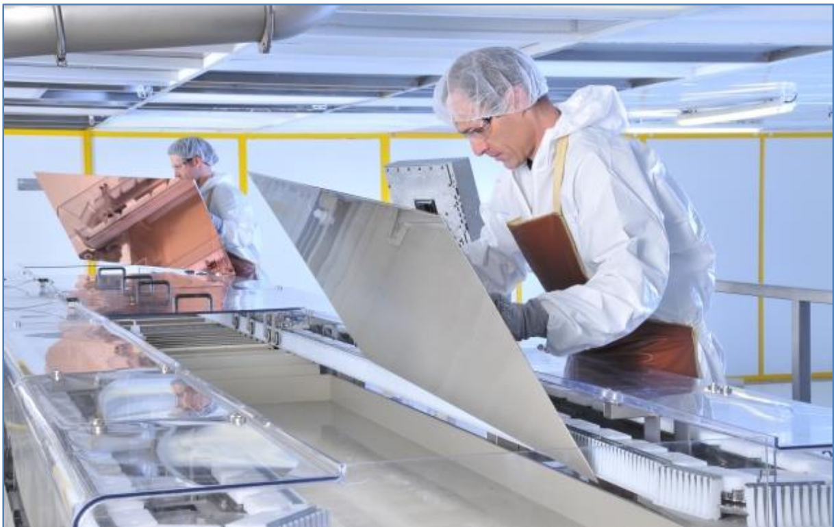
Figure 2-5: Photographie de l'équipement d'électrodéposition du précurseur métallique sur substrat de taille 60x120cm 2 (ligne pilote Nexcis).
