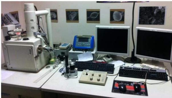
Figure II-6 : Microscope électronique à balayage Jeol JSM 6460LV
