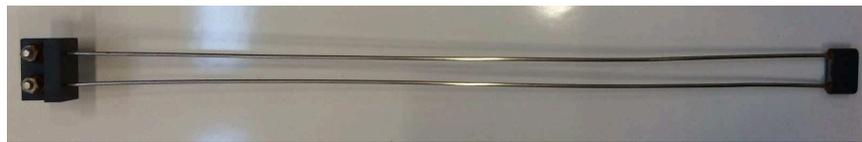
FIGURE 3.5 Sonde à houle de type résistif
