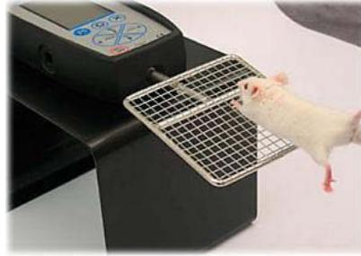
Figure 2 : Exemple de dynamomètres utilisés pour mesurer la force musculaire par grip test chez l'homme et chez le rongeur.
