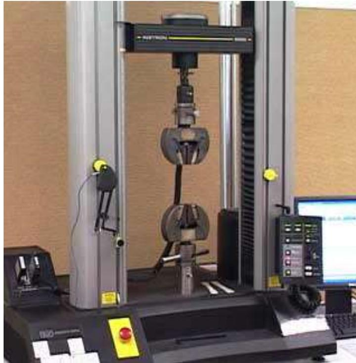
*Figure 47. Dispositif expérimental de la machine de traction uniaxiale utilisée.*
