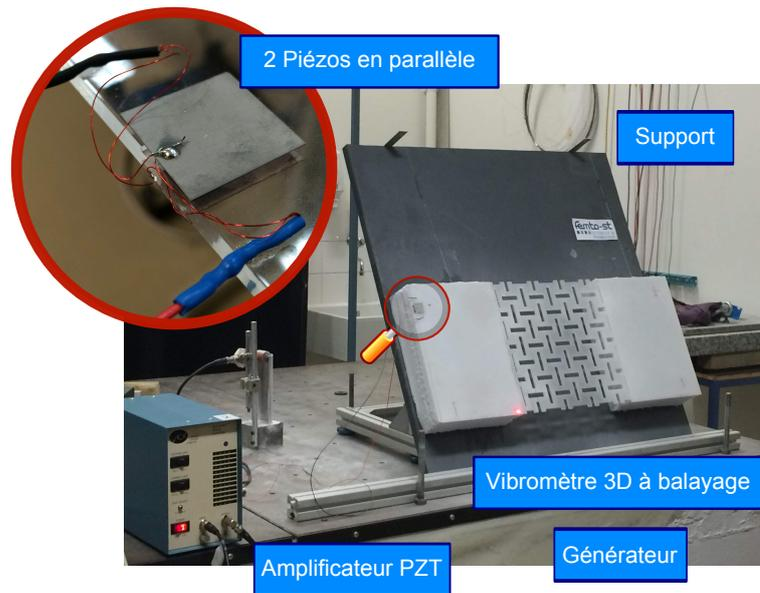
FIGURE 2.27 – Premier dispositif expérimental avec comme éléments principaux le métamatériau et le vibromètre 3D à balayage pour la mesure, un zoom est effectué sur le système excitateur, deux patchs piézoélectriques en parallèle.
