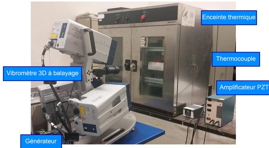
FIGURE 4.16 – Dispositif expérimental avec comme éléments principaux le métamatériau dans l'enceinte thermique et le vibromètre 3D à balayage pour la mesure.
