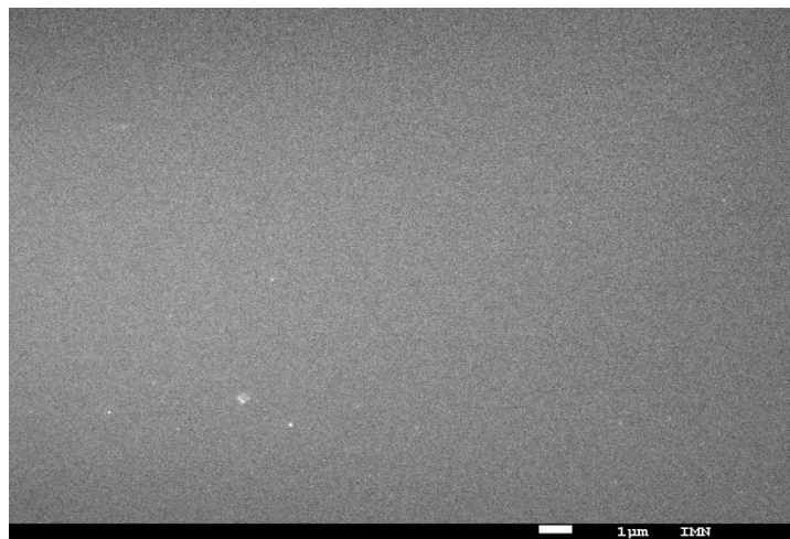
Figure III-14 : Visualisation de la surface d'un film mince de BSTV
