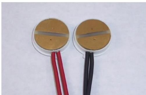
*Figure 30 - Les deux électrodes d'un électroglottographe. Ces électrodes sont maintenues en position sur le cou du locuteur par un collier élastique.*
