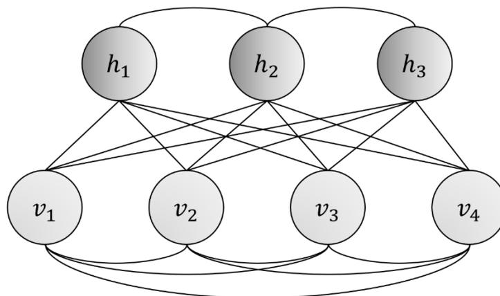
*Figure 24 - Illustration d'une machine de Boltzmann. Dans une machine de Boltzmann, des connexions existent entre les différentes unités cachées et les différentes unités visibles, d'après [78]. Les unités visibles sont les unités dont l'état peut être observé. L'état des unités cachées n'est pas spécifié par les données observables.*
