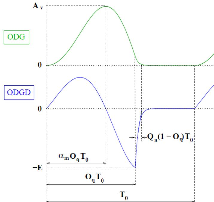
Figure 21 - Représentation d'une période de l'ODG et de sa dérivée. Le paramètre de source  $A_v$  désigne l'amplitude de voisement,  $T_0$  la période fondamentale,  $O_q$  le quotient ouvert,  $\alpha_m$  le coefficient d'asymétrie,  $Q_a$  le quotient de phase de retour et  $E$  la vitesse de fermeture. Leur interprétation est donnée dans le Tableau 1. D'après [17].
