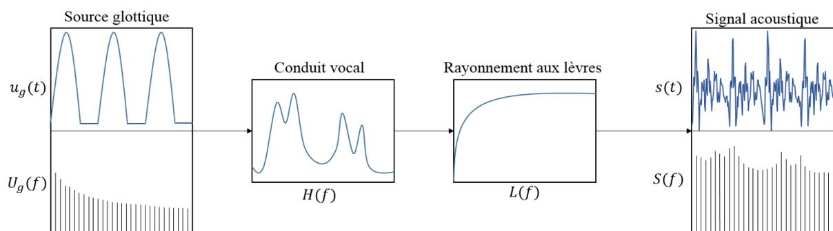
Figure 15 - Illustration du modèle source-filtre. Le produit des transformées de Fourier de la source glottique  $U_g(f)$ , de la transformée de Fourier du conduit vocal  $H(f)$  et de la transformée de Fourier du rayonnement aux lèvres  $L(f)$  donne un signal acoustique de représentation fréquentielle  $S(f)$ .
