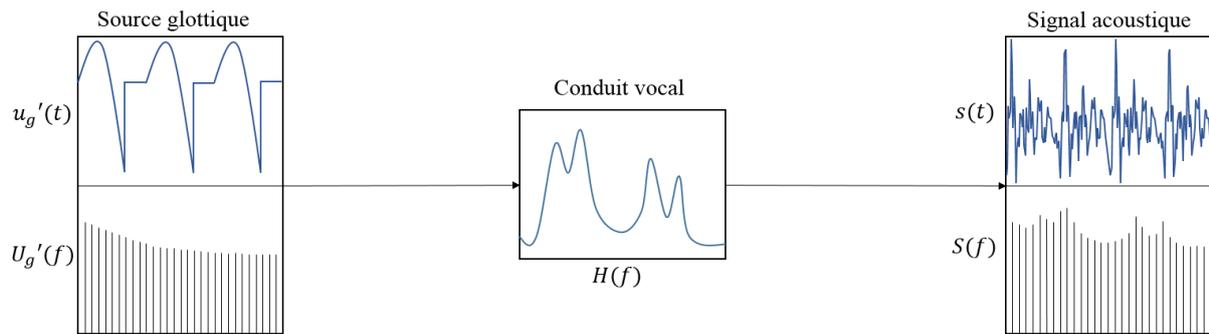
Figure 16 - Illustration du modèle source-filtre en tenant compte du rayonnement aux lèvres par dérivation du signal de source. Le produit de la transformée de Fourier de la source glottique dérivée  $U_g'(f)$  par la transformée de Fourier du conduit vocal  $H(f)$  produit le même signal acoustique de représentation fréquentielle  $S(f)$  que celui montré. D'après [17].
