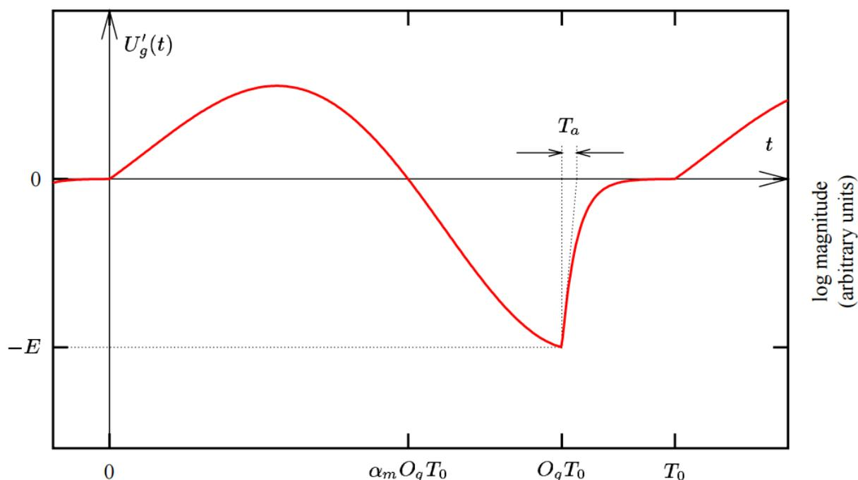
Figure 58 – Modèle d'onde de débit glottique dérivée. Sur cette figure sont représentés les paramètres du modèle CALM.
