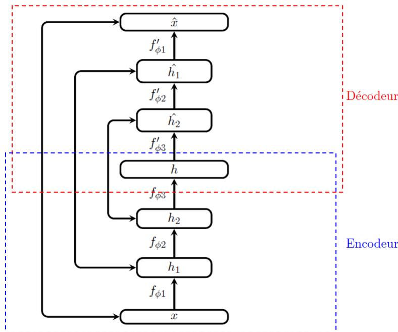
Figure 27 – Un exemple d'autoencodeur. Sa sortie  $\hat{x}$  est la reconstruction de l'entrée  $x$  à partir de la représentation cachée  $h$ .
