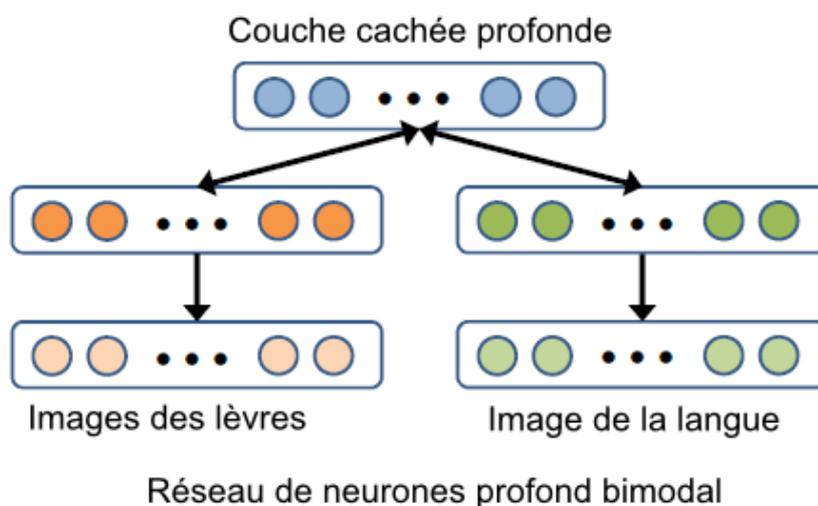
Figure 53 - Exemple de réseau de neurones profond bimodal. Chaque entrée est d'abord traitée séparément à l'aide de RBM séparés puis les couches cachées ainsi extraites servent d'entrée à un RBM dont le but est d'extraire une représentation commune des données, d'après [125].
