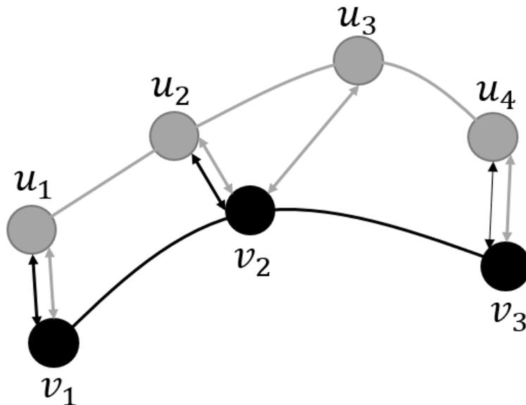
Figure 43 – Représentation simplifiée de deux sous-parties de deux contours. Les quatre grandeurs  $u_1$ ,  $u_2$ ,  $u_3$  et  $u_4$  représentent les coordonnées  $(x, y)$  de trois points adjacents du contour gris. De même, les trois grandeurs  $v_1$ ,  $v_2$  et  $v_3$  représentent les coordonnées  $(x, y)$  de trois points adjacents du contour noir. La comparaison de deux courbes de contour en utilisant le MSD permet de comparer ces contours même s'ils n'ont pas le même nombre de points.
