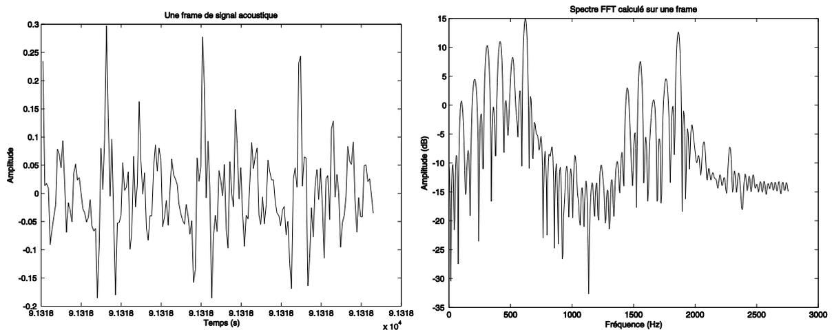
Figure 13 - Une trame de signal et le spectre calculé sur cette trame.
