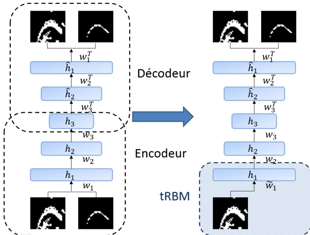
Figure 40 – Autoencodeur d'origine (à gauche) et autoencodeur modifié (à droite) pour extraire automatiquement les contours de langue à partir d'une image échographique prétraitée. La partie inférieure désigne l'encodeur, alors que la partie supérieure désigne le décodeur.
