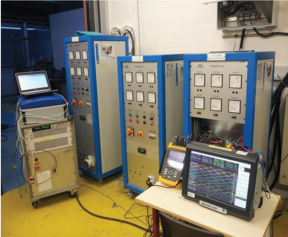
Figure II-9 – Vue partielle du matériel d'expérimentation (de gauche à droite : onduleur avec source DC, auto-transformateur, analyseur de puissance et centrale d'acquisition)
