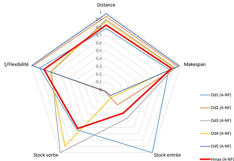
FIGURE 3.7 – Comparaison graphique des différentes stratégie d’ordonnancement dans le cas d’un atelier type A-NF
