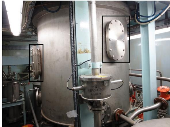
FIGURE 5.6 – Brides en acier sur la cuve du réacteur.
