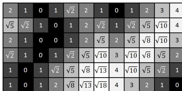
Figure 27 : Carte de distance  $L^2$  pour l'image utilisée sur la Figure 26. Elle n'est pas déterminable par simple propagation.
