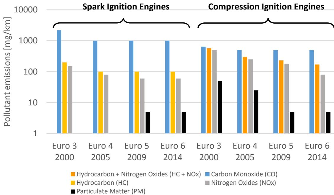
**Figure 7.** Evolutions des valeurs limites des émissions polluantes pour les véhicules légers à moteurs à allumage commandé (à gauche) et à moteurs à allumage par compression (à droite) [8]. Remarque : les particules apparaissent pour les moteurs à allumage commandé à partir de la norme Euro 5 avec le développement de l'injection directe stratifiée.
