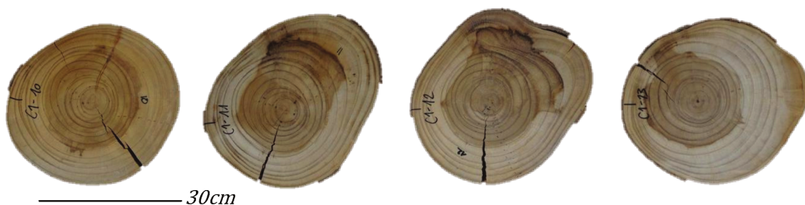
Figure 78 : Observation de la mise en place de duramen traumatique chez C. alliodora . Les rondelles ont été prélevées à 10, 11, 12 et 13 m et appartiennent à l'individu 1. Avant et après les deux zones dont la proportion de duramen est anormalement forte (11 et 12 m), les rondelles présentent une zone de duramen normale, centrée sur la moelle. Ce type de singularité explique en partie les hétérogénéités observées dans les profils de variation de la proportion de duramen selon la hauteur dans l'arbre. La formation de duramen traumatique s'accompagne d'une augmentation locale de la production de matière ligneuse, que l'on observe facilement sur les rondelles à 11 et 12 m.
