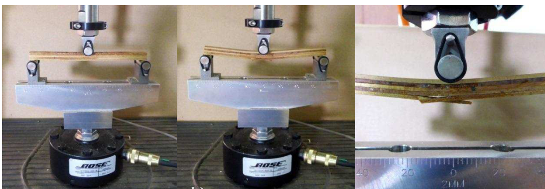
Figure 117 : Observation d'un essai de flexion 3 points jusqu'à la rupture sur un multipli contrefilé sec collé à l'époxy. a) phase initiale ; b) déplacement progressif du bras de force c) rupture de l'éprouvette sans délamination.
