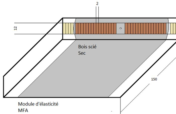
**Figure 146 : Plan de découpe des échantillons de module à partir des planches diamétrales prélevées sur les individus. Les échantillons sont découpés dans l'aubier (en beige) comme dans le duramen (en marron).**
