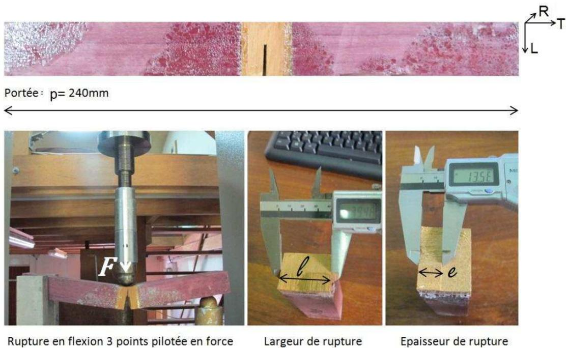
**Figure 111 : Dimensions des éprouvettes et étapes du test de ténacité sur des blocs contrefilés de bagasse. Les dimensions (largeur  $l$  et épaisseur  $e$ ) de la surface de fente après rupture sont mesurées au pied à coulisse.**
