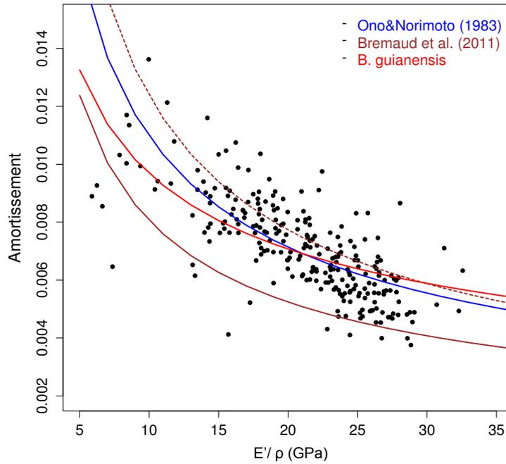
**Figure 167 : Modèle de variation de l'amortissement en fonction du module spécifique chez *B. guianensis*. Le trait bleu représente le modèle d'Ono&Norimoto (1993). Les traits marron pleins et pointillés sont issus des travaux de Bremaud et al. (2011) et représentent respectivement les modèles associés aux essences dont le taux d'extractible est inférieur à 5 % et supérieur à 7 %. Le modèle ajusté aux observations pour *B. guianensis* est représenté en rouge.**
