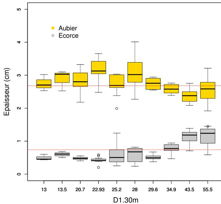
**Figure 36: Variabilité de l'épaisseur d'aubier et d'écorce à 1,30 m en fonction du  $D_{1.30m}$  chez *B. guianensis*. Les lignes pointillées rouges représentent les médianes propres à chaque type de tissu.**
