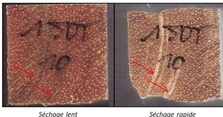
**Figure 145 : Influence du type de séchage sur l'apparition de collapse dans les zones de bois de tension chez *B. guianensis*. Les deux échantillons sont proches et possèdent les mêmes zones de bois de tension (indiquées par les flèches rouges).**
