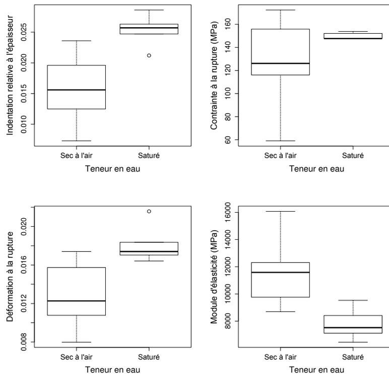
**Figure 122 : Résultats obtenus lors du test préliminaire de flexibilité pour l'échantillonnage de calibration Calibr.2. La variabilité des résultats selon la teneur en eau des éprouvettes est observée, de haut en bas et de droite à gauche, pour les paramètres suivants : indentation relative à l'épaisseur ; contrainte à la rupture ; déformation à la rupture ; module d'élasticité.**
