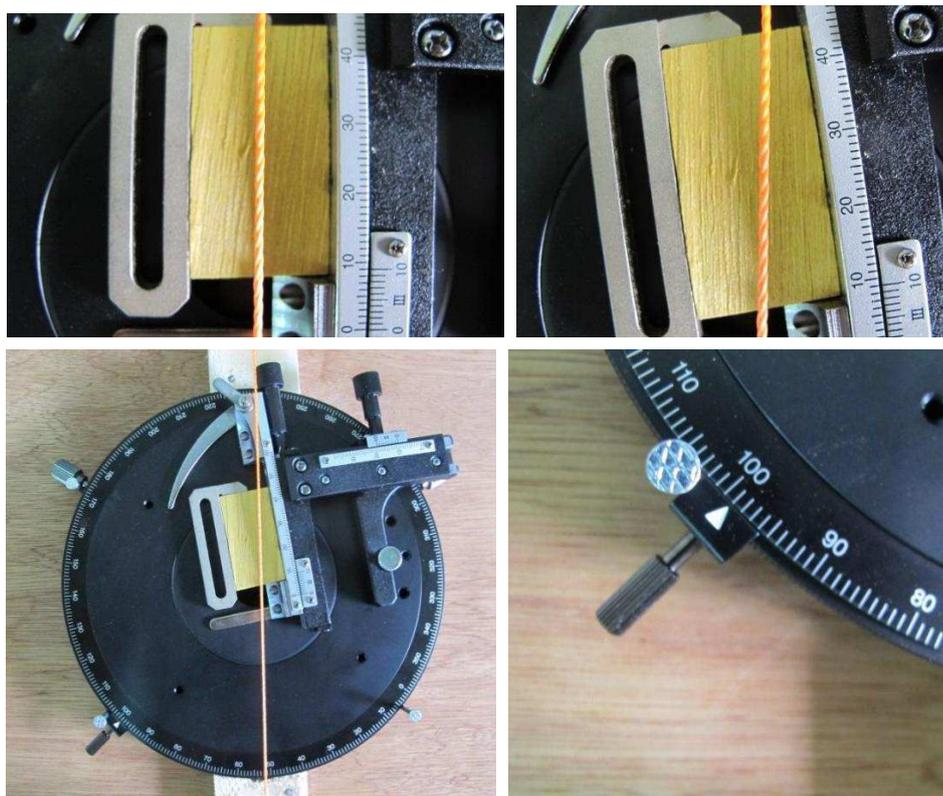
**Figure 108 : Mesure de l'angle moyen du fil d'échantillons de bagasse à l'échelle millimétrique à l'aide d'un goniomètre. Les mesures sont effectuées visuellement sur la face LT d'échantillons fendus longitudinalement. L'alignement de la direction moyenne du fil de l'échantillon avec le repère vertical permet de lire l'angle de déviation du fil (ici 9°).**
