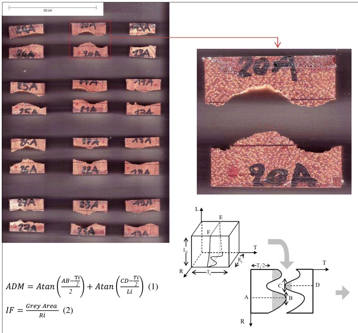
**Figure 110 : Mesure du contrefil à l'échelle macroscopique sur les blocs de bagasse fendus à l'aide du logiciel Image J. Les deux parties constituant initialement chaque éprouvette sont scannées, puis la mesure des longueurs AB, CD, T<sub>1</sub>, R<sub>i</sub> et de l'aire hachurée en gris permettent le calcul des deux indices caractérisant le contrefil au sein de l'échantillon : ADM, l'angle de déviation moyen du fil ; et IF, l'indice du fil. Dessin de P. Cabrolier**
