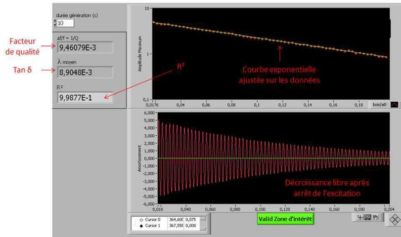
**Figure 154 : Visualisation de l'écran de commande lors de la décroissance libre après excitation. La décroissance en amplitude en fonction du temps donne accès au décrément logarithmique de l'amplitude (calculée grâce à la courbe exponentielle ajustée aux données en haut de la fenêtre de visualisation).**
