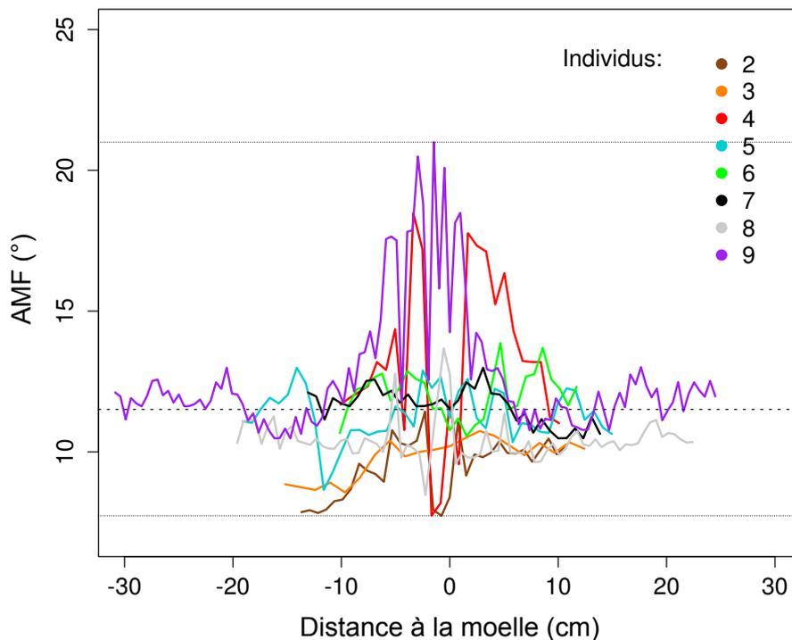
**Figure 48 : Variation de l'AMF selon le rayon sur les rondelles bases des individus de *B. guianensis*. Les traits pointillés et le trait mixte représentent respectivement les valeurs extrêmes et la valeur médiane pour l'ensemble de l'échantillonnage.**
