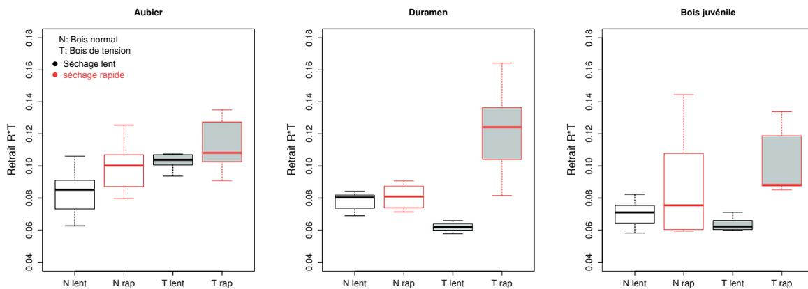
**Figure 144 : Variabilité du retrait surfacique selon le type de bois et le processus de séchage chez *B. guianensis*. Le retrait surfacique correspond à la somme des retraits R et T. Les boîtes à moustaches dont le fond est gris correspondent aux échantillons qui contiennent du bois de tension. Celles dont le contour est rouge correspondent aux résultats obtenus avec un séchage rapide. Par bois juvénile on entend le bois situé à cœur (diamètre < 5cm).**
