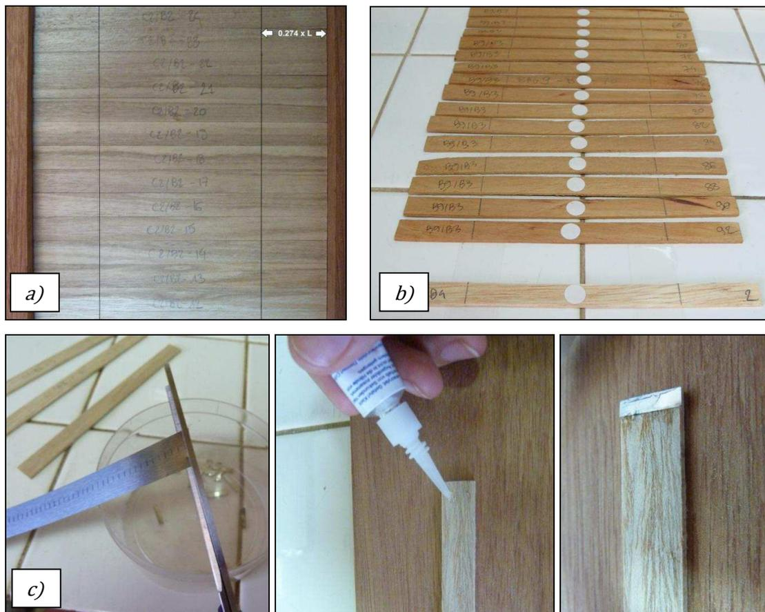
**Figure 149 : Préparation des échantillons de module après découpe pour les mesures vibratoires.**
