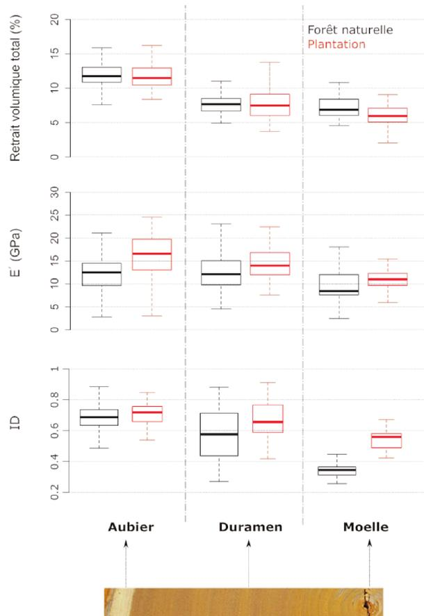
**Figure 184 : Comparaison entre les traits du bois des espèces issues de forêt naturelle et de plantation pour *B. guianensis*. De haut en bas : observation des valeurs de retrait, de module d'élasticité et d'infradensité en fonction des différents types de bois entre les individus prélevés en forêt naturelle échantillonnés au cours de la thèse (en noir) et les individus de plantation échantillonnés au cours du projet Feder « ForesTree Culture » (en rouge).**
