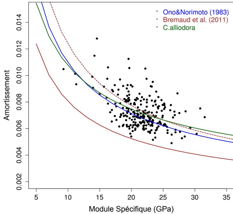
**Figure 170 : Variations de l'amortissement en fonction du module spécifique chez *C. alliodora*.** Le trait bleu représente le modèle d'Ono&Norimoto (1993). Les traits marron pleins et pointillés sont issus des travaux de Bremaud et al.(2011) et représentent respectivement les modèles associés aux essences dont le taux d'extractible est inférieur à 5 % et supérieur à 7 %. Le modèle ajusté aux observations pour *C. alliodora* est représenté en vert.
