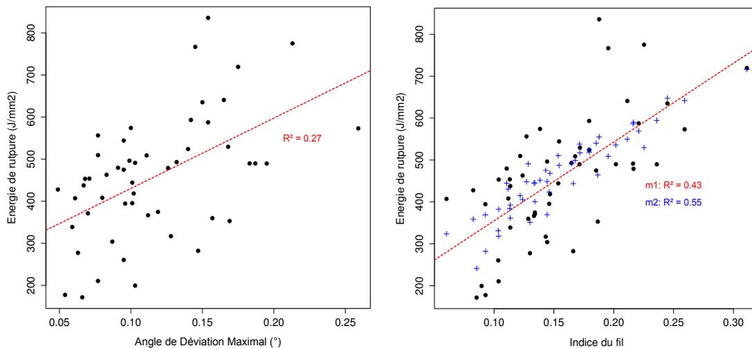
**Figure 120 : Influence de la variation de l'angle du fil au sein des échantillons de bagasse sur les valeurs de ténacité. Variation de l'énergie de rupture selon : l'Angle de Déviation Maximal (ADM) et l'Indice du Fil (IF) à droite. Les droites pointillées rouges représentent les modèles linéaires simples. Les croix bleues correspondent aux prédictions du modèle linéaire mixte m2.**
