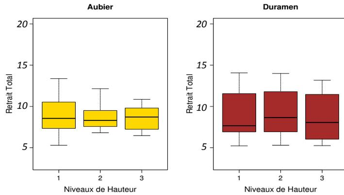
**Figure 138 : Retrait volumique total en % dans l'aubier et le duramen selon le niveau de hauteur dans l'arbre chez *C. alliodora*. (1 : 1.30m ; 2 : mi-hauteur ; 3 : sous fourche). Aucun des groupes n'est significativement différent des autres (Tukey).**
