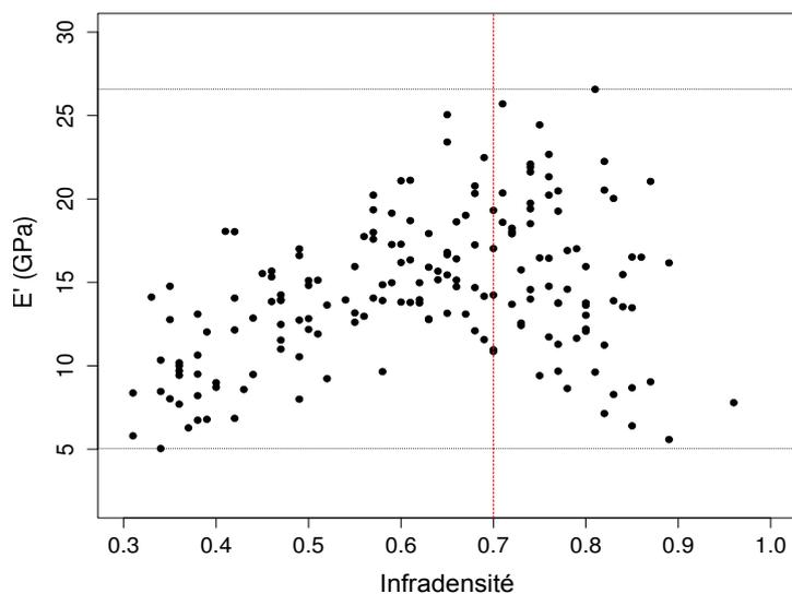
**Figure 164 : Influence de l'infradensité sur le module d'élasticité chez *B. guianensis*. Les traits pointillés représentent les valeurs extrêmes de module mesurées pour l'espèce. Le trait mixte rouge indique la valeur d'infradensité à partir de laquelle la tendance s'inverse, soit 0,7.**
