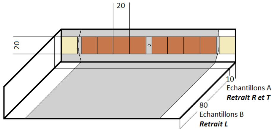
**Figure 127 : Plan de découpe des échantillons de retrait à partir des planches diamétrales prélevées sur les individus. Les échantillons sont découpés dans l'aubier (en beige) comme dans le duramen (en marron). Chaque planche permet la découpe des échantillons de type A destinés à l'analyse du retrait radial et le retrait tangentiel, ainsi des échantillons de type B destinés à l'analyse du retrait longitudinal.**
