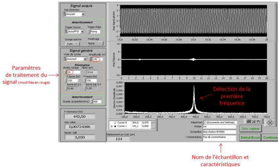
Figure 152 : Visualisation de l'écran de commande après le 1<sup>er</sup> balayage et détection du 1<sup>er</sup> pic de fréquence.
