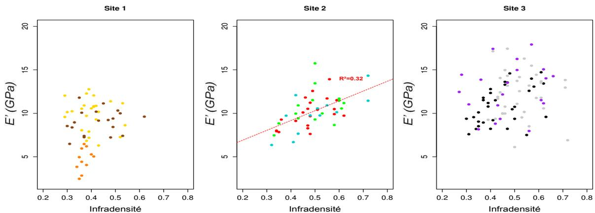
**Figure 168 : Variation du module en fonction de l'infradensité selon le site de prélèvement chez *C. alliodora*. A chaque couleur correspond un individu, comme indiqué en légende.**
