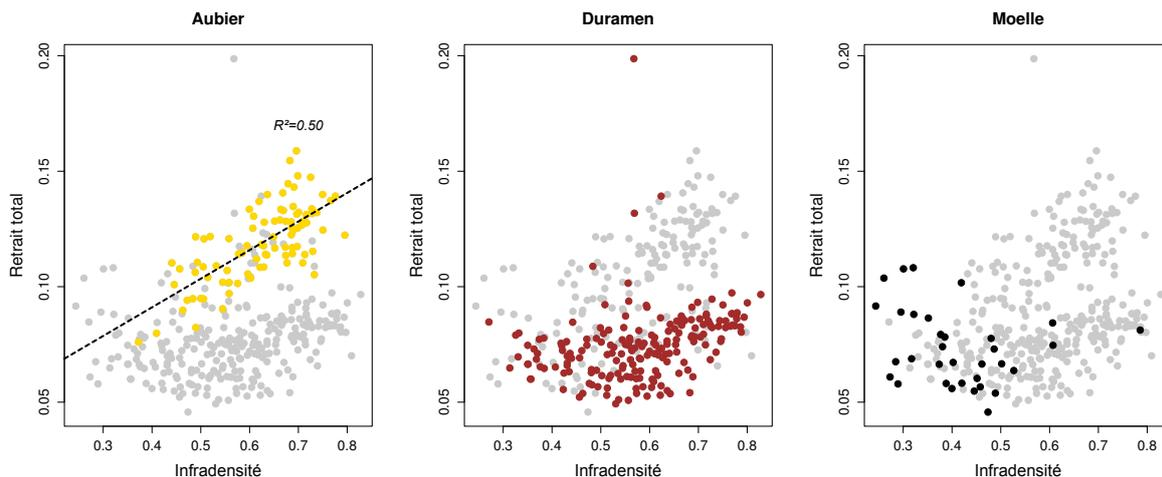
**Figure 139 : Influence de l'infradensité sur le retrait volumique selon le type de bois chez *B. guianensis*. Les points gris permettent de situer les points d'aubier (en jaune), de duramen (en marron) et de moelle (en noir) en fonction du reste de l'échantillonnage. Dans l'aubier seulement, le retrait volumique total augmente linéairement avec l'infradensité ( $R^2=0,50$ ).**
