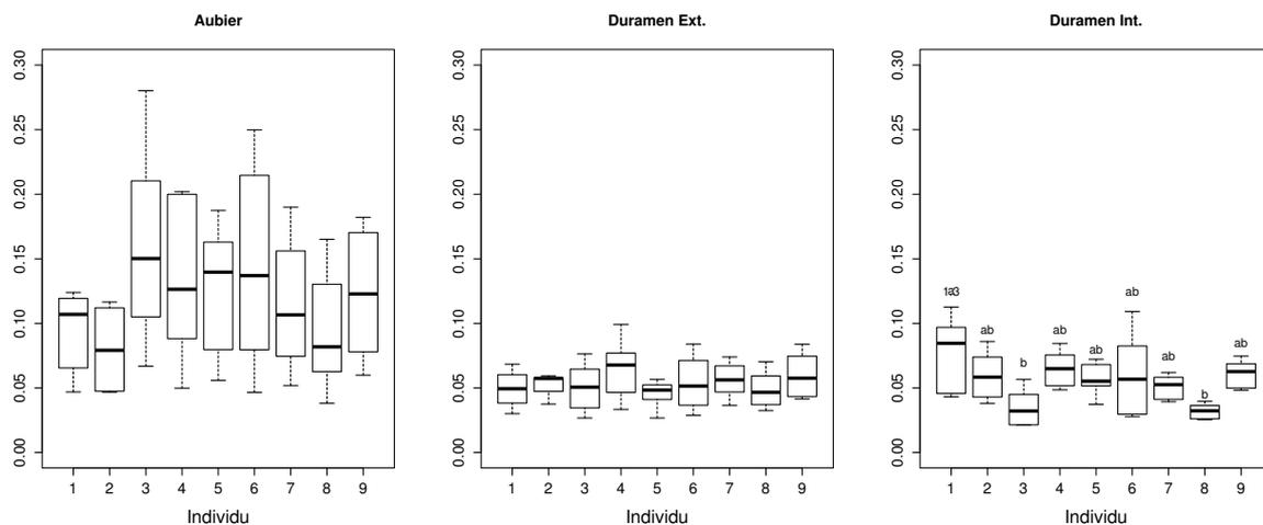
**Figure 177: Coefficient de variabilité de la perte de masse à 6 mois en fonction des individus et du type de bois chez *B. guianensis*.**
