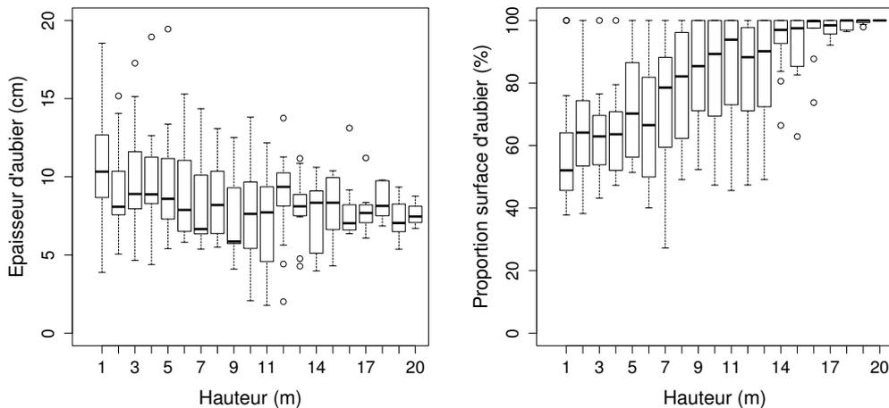
**Figure 45 : Variabilité de l'épaisseur et de la proportion d'aubier en fonction du niveau de hauteur chez *C. alliodora*.**
