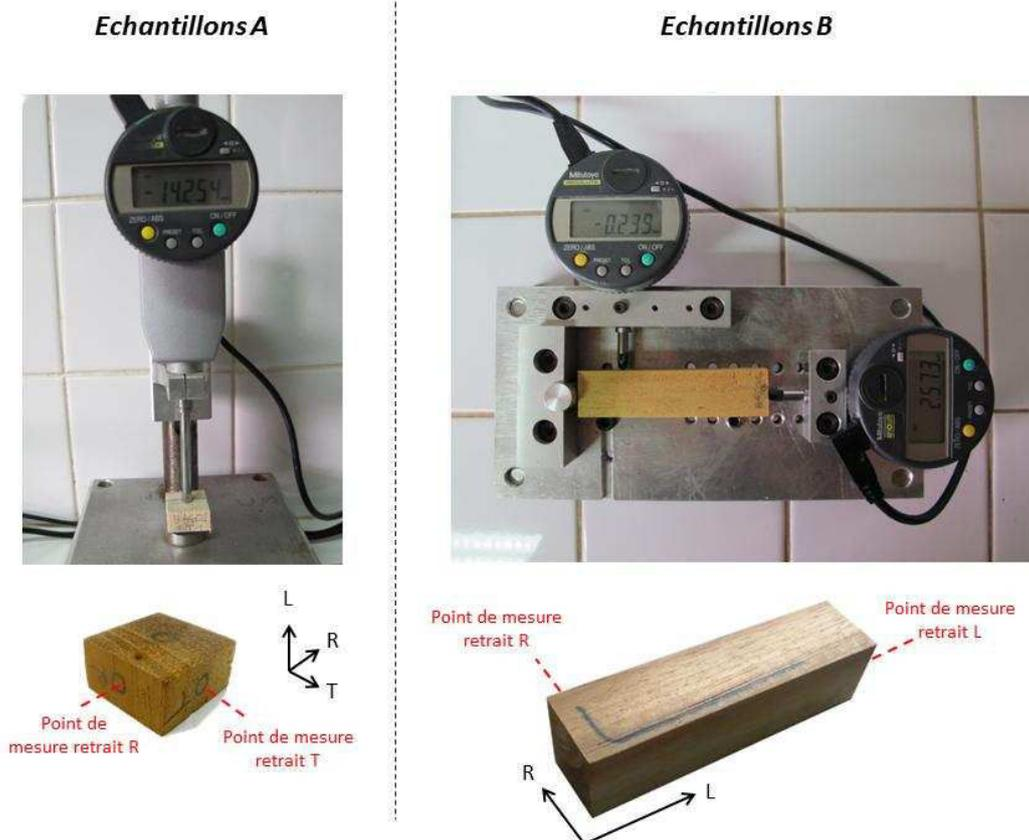
**Figure 128 : Détail du dispositif de mesure pour l'analyse du retrait selon le type d'échantillons. Le retrait radial et le retrait tangentiel sont mesurés sur les échantillons de type A à l'aide d'un comparateur micrométrique ; le retrait longitudinal est mesuré sur les échantillons de type B, à l'aide du dispositif mis au point par François Sassus (1998).**
