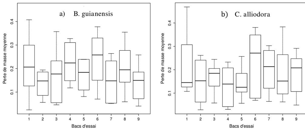
**Figure 175 : Variabilité de la perte de masse à 6 mois des échantillons témoin de yayamadou dans chaque bac. (1=100% de perte de masse). Ces échantillons représentent l'activité fongique du milieu de culture propre à chaque individu pour les échantillons de *B. guianensis* (à gauche) et de *C. alliodora* (à droite). Le test de Tukey indique qu'aucun des groupes n'est significativement différent des autres.**
