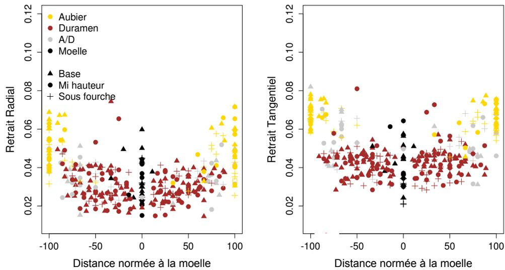
Figure 132 : Retrait radial et tangentiel en fonction de la distance normée à la moelle selon le type de bois et la hauteur de prélèvement dans l'arbre chez *B. guianensis*.
