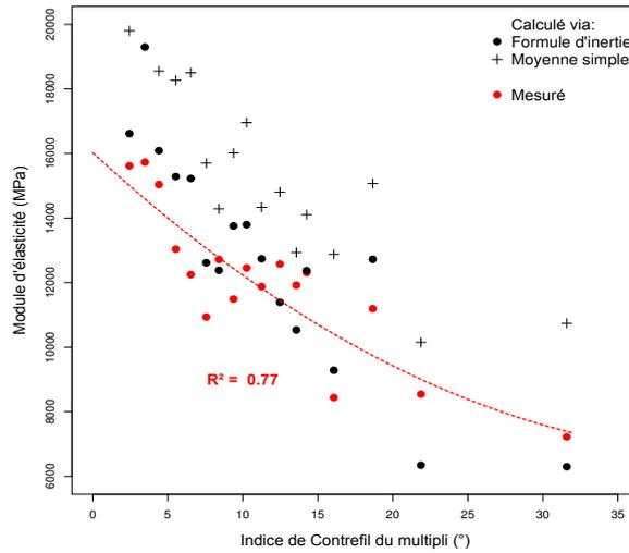
**Figure 123 : Variation du module d'élasticité de l'éprouvette sèche selon l'ICF et comparaison aux valeurs calculées. Les points rouges représentent les valeurs mesurées. Les ronds et les croix noires correspondent aux modules calculés Inertie et Emoy. La droite pointillée rouge représente le modèle ajusté pour les valeurs mesurées ( $R^2=0,77$ ).**
