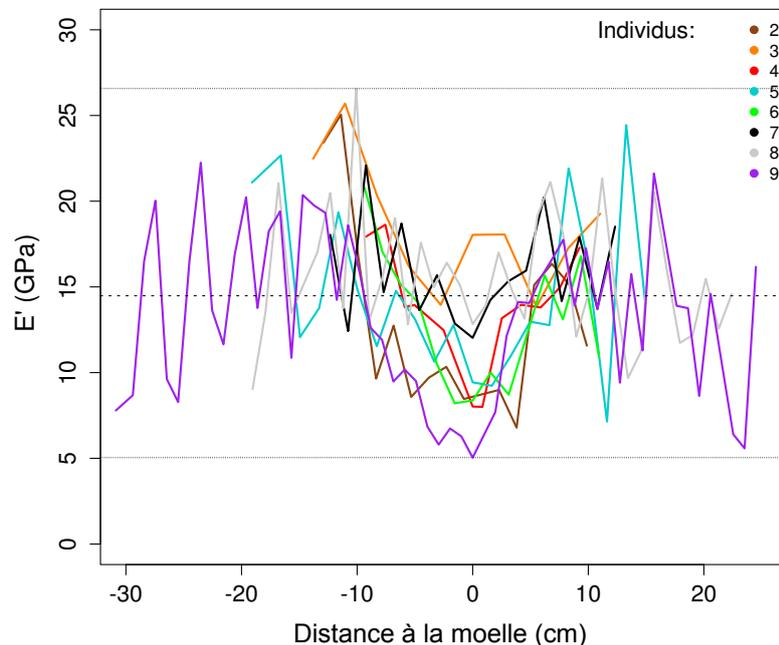
**Figure 156 : Variations du module d'élasticité en fonction de la distance à la moelle selon les individus chez *B. guianensis*. Les valeurs extrêmes sont indiquées par les lignes pointillées et la moyenne par le trait mixte.**
