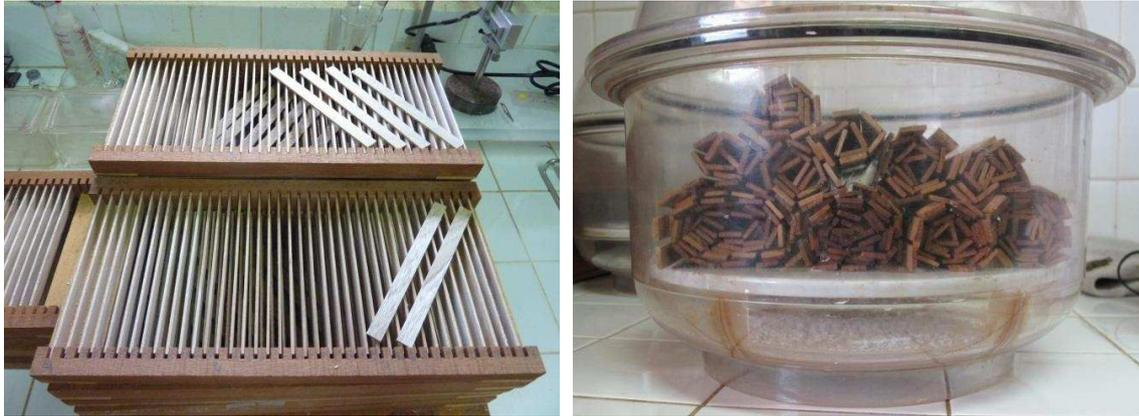
**Figure 150 : Conditionnement et stabilisation hygrométrique des échantillons avant la mesure du module.**
