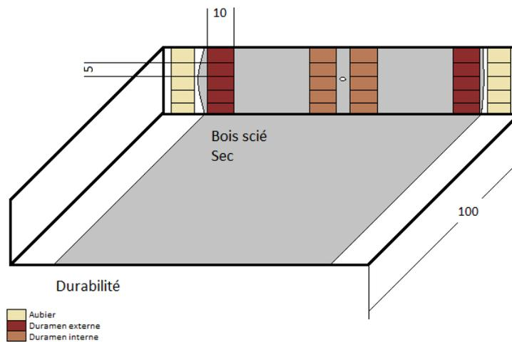
**Figure 173: Plan de découpe des échantillons de durabilité à partir des planches diamétrales prélevées sur les individus. Les échantillons sont découpés dans l'aubier (en beige), le duramen externe (en marron foncé) et le duramen interne (marron clair).**
