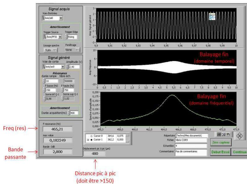
Figure 153 : Visualisation de l'écran de commande après le 2<sup>nd</sup> balayage et confirmation du 1<sup>er</sup> pic de fréquence détecté. La précision de la mesure (ici 465.21 Hz) peut être vérifiée à ce stade grâce à l'indicateur « Distance pic à pic » qui doit être supérieur à 150 µm (ici 480µm).
