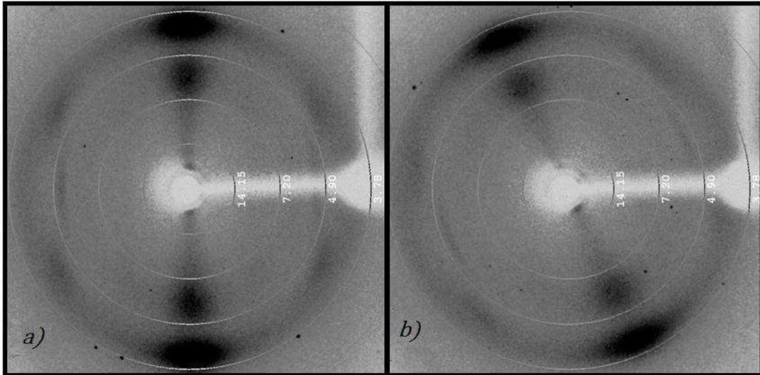
**Figure 109 : Mesure de l'angle du fil à l'échelle microscopique par la méthode de diffraction aux rayons X. Observation de la diffraction et de la déviation du faisceau incident perpendiculaire à la surface d'un échantillon a) de fil droit, b) de fil incliné.**
