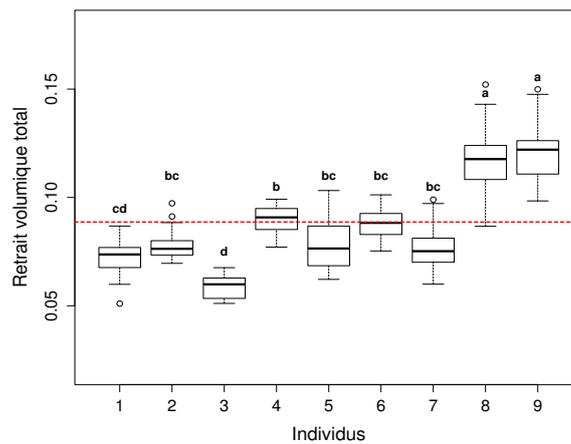
**Figure 134 : Variabilité des résultats de retrait total volumique selon les individus chez *C. alliodora*. La ligne pointillée rouge représente la valeur moyenne de retrait volumique pour l'ensemble de l'échantillonnage.**
