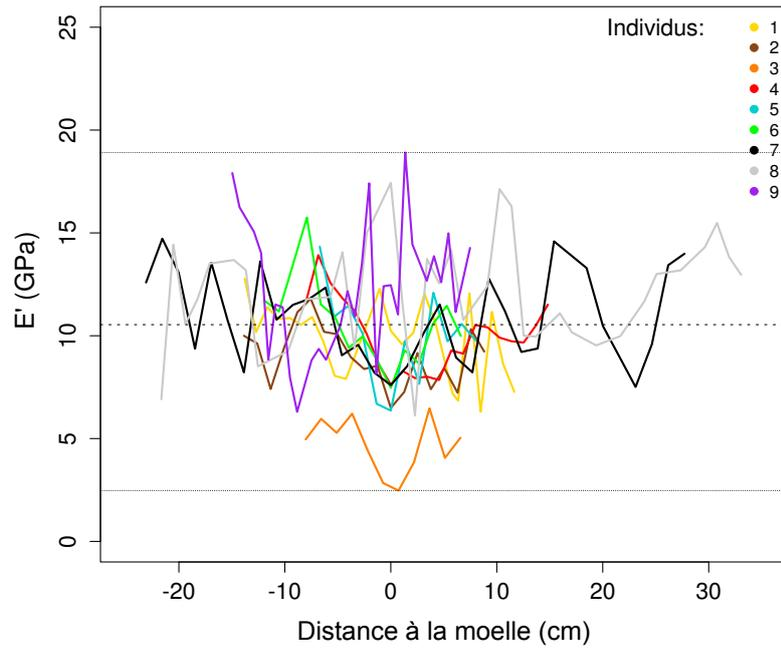
**Figure 160 : Variations du module d'élasticité en fonction de la distance à la moelle selon les individus chez *C. alliodora*. Les valeurs extrêmes sont indiquées par les lignes pointillées et la moyenne par le trait mixte.**
