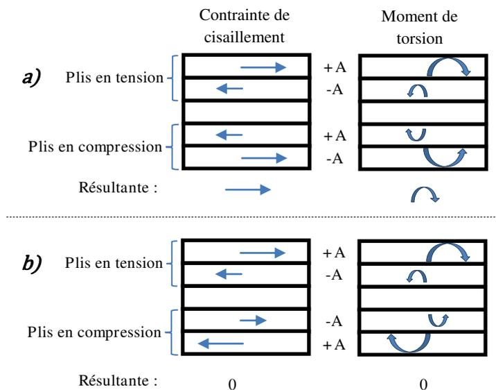
**Figure 112 : Choix de l'organisation des plis au sein des éprouvettes de bagasse artificiellement contrefilés. Comparaison de la résultante de cisaillement et des moments de torsion dans le cas d'une organisation : a) symétrique ou b) antisymétrique. Les plis possèdent un angle d'inclinaison des fibres positif (+A) ou négatif (-A).**
