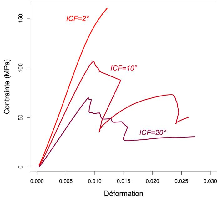
**Figure 125 : Profils de contrainte-déformation pour les multi-plis de bagasse correspondant à un ICF de 2, 10 et 22°. (Le profil du multi-ply dont l'ICF vaut 10° présente une brusque chute de la contrainte et une diminution de la déformation dues à un rebond de la tige lors de la rupture de l'échantillon).**
