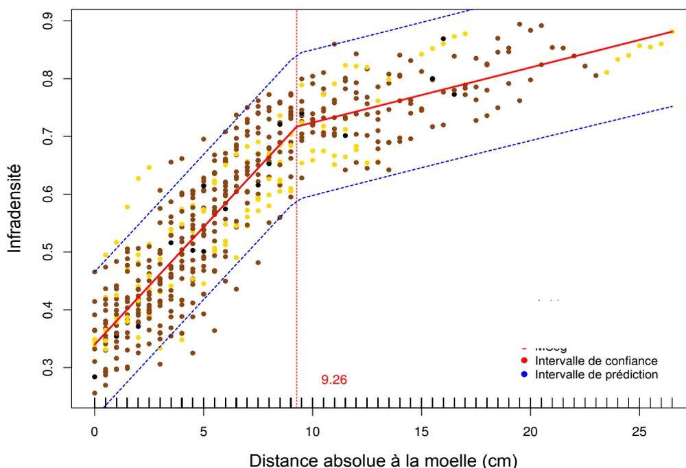
**Figure 90 : Infradensité en fonction de la distance absolue à la moelle pour l'ensemble des individus de bagasse. Le modèle segmenté calculé est représenté en rouge. La limite de linéarité est indiquée par le trait rouge en pointillé, pour une distance à la moelle de 9,26 cm. Les traits en pointillés bleus définissent l'intervalle de confiance du modèle.**
