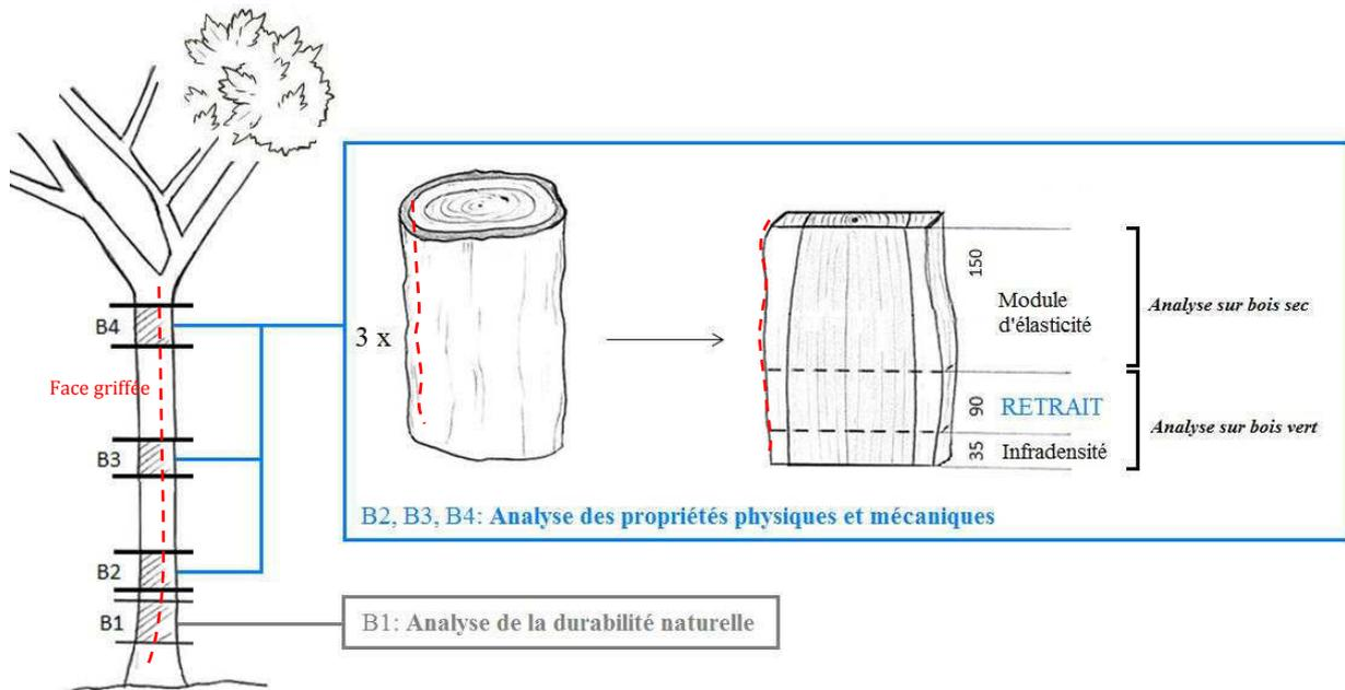
**Figure 126 : Détail du billonnage des individus sélectionnés et de la découpe des planches diamétrales. La face griffée (trait pointillé rouge) permet de conserver l'orientation des échantillons même après découpe.**
