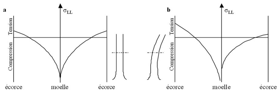
**Figure 7 : Schématisation des contraintes dans a) un arbre droit équilibré ; b) un arbre penché.**
