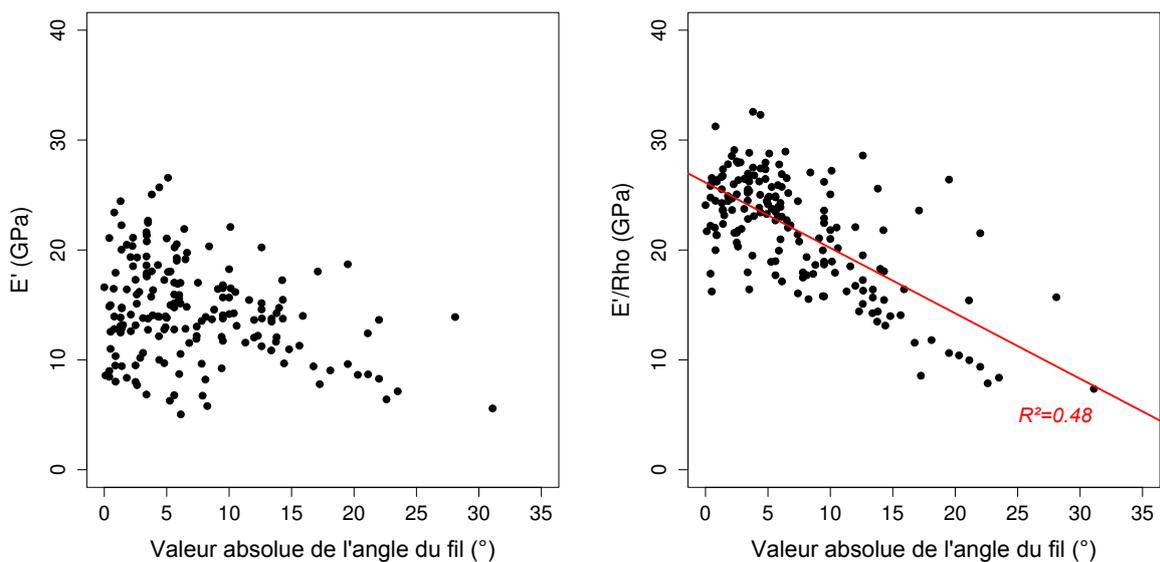
**Figure 165 : Influence de l'angle du fil sur le module d'élasticité et sur le module spécifique chez *B. guianensis*. Le module spécifique décroît linéairement avec la valeur absolue du fil, selon le modèle linéaire simple représenté en rouge ( $R^2 = 0,48$ ).**
