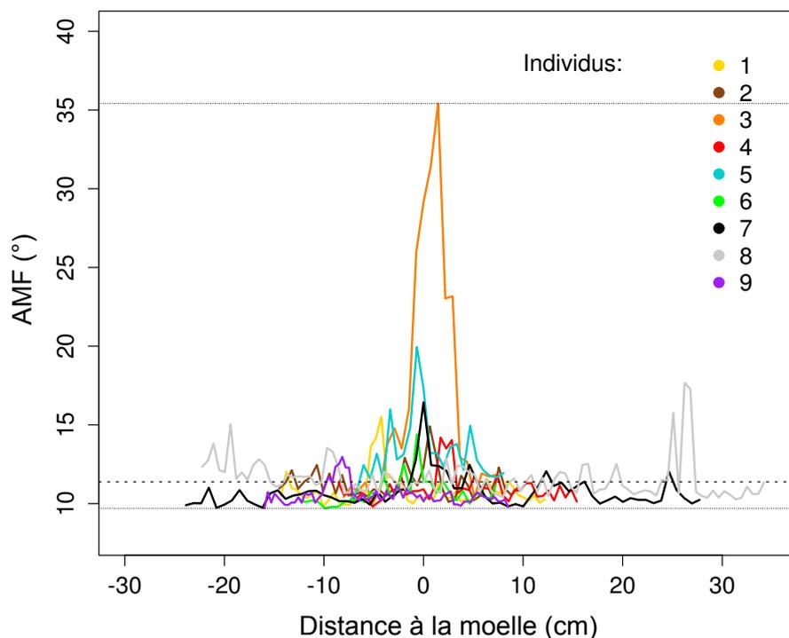
Figure 49 : Variation de l'AMF selon le rayon sur les rondelles bases des individus de *C. alliodora*. Les traits pointillés et le trait mixte représentent respectivement les valeurs extrêmes et la valeur médiane pour l'ensemble de l'échantillonnage.
