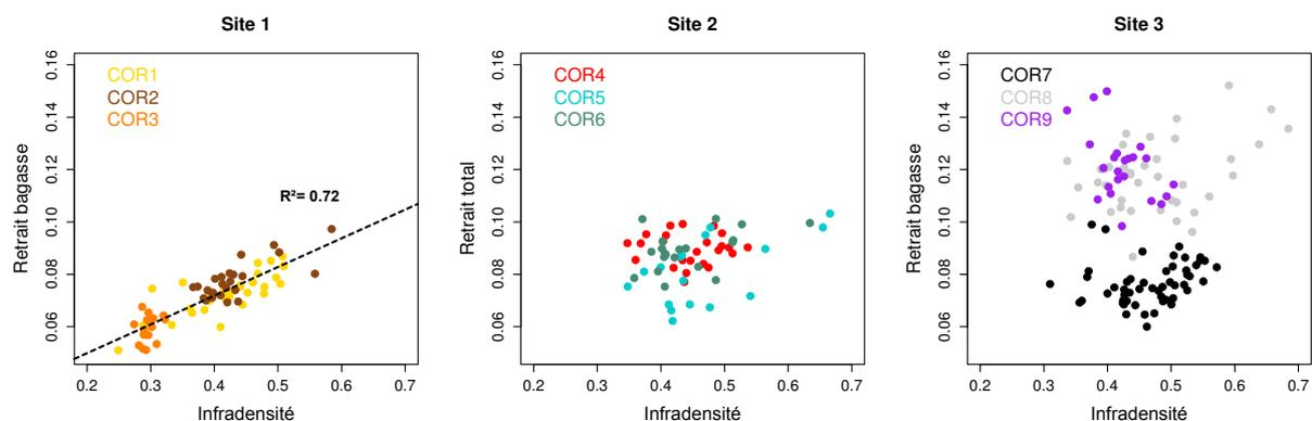
**Figure 141 : Influence de l'infradensité sur le retrait volumique selon le site de prélèvement chez *C. alliodora*. A chaque couleur correspond un individu, comme indiqué en légende. Pour les individus du site 1 seulement, le retrait augmente linéairement avec l'infradensité ( $R^2=0,72$ ).**
