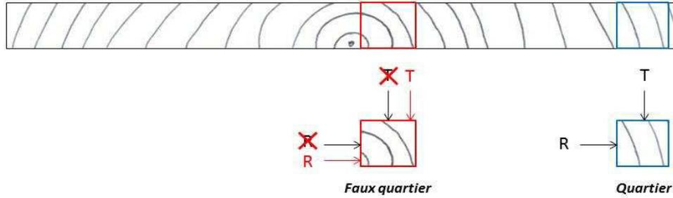
**Figure 129 : Ajustement de la mesure de retrait, dans le cas d'échantillons de type A usinés sur faux quartier.**
