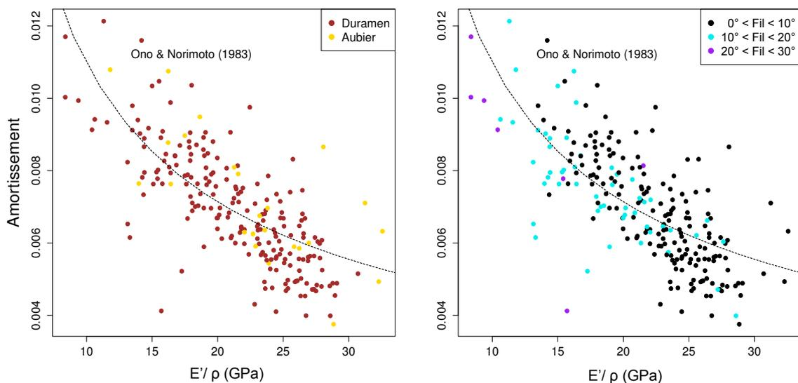
**Figure 166 : Variations de l'amortissement en fonction du module spécifique chez *B. guianensis*. Les traits pointillés noir représentent le modèle d'Ono & Norimoto (1993). A gauche, la couleur des points correspond au type de bois (duramen ou aubier) ; à droite, la couleur des points correspond au niveau d'inclinaison du fil dans l'échantillon comme indiqué en légende.**
