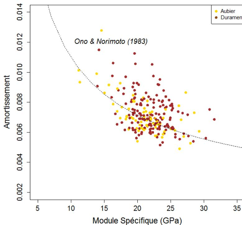
**Figure 169 : Variations de l'amortissement en fonction du module spécifique chez *C. alliodora*. Les traits pointillés noir représentent le modèle d'Ono&Norimoto (1993). La couleur des points correspond au type de bois (duramen ou aubier) comme indiqué en légende.**
