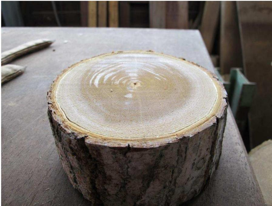
**Figure 30 : Observation d'une zone de bois de tension chez un individu de *B. guianensis* à la lumière rasante. La surface brillante correspond à la zone de bois de tension.**
