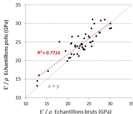
**Figure 155 : Influence de l'état de surface sur la mesure du module spécifique avec la méthode vibratoire. Différence observée entre les échantillons bruts et polis. La droite pointillée en noir correspond à la droite  $y=x$  et la droite de régression ajustée à partir des mesures est indiquée en rouge ( $R^2 = 0,7714$ ). Le polissage des échantillons bruts pelucheux induit une légère augmentation du module spécifique.**
