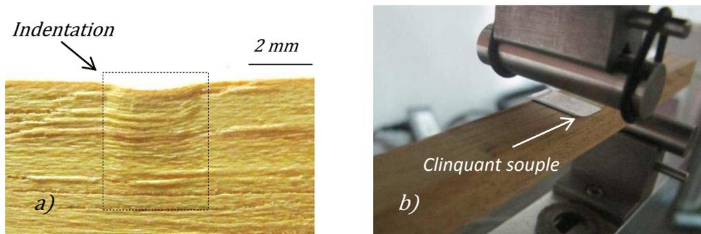
**Figure 116 : Cas d'indentation lors de l'essai de flexion sur des échantillons de massif et résolution du problème. a) Détail de l'effet de l'indentation sur les fibres de l'échantillon ; b) installation d'un clinquant souple sur la face supérieure de l'échantillon pour limiter l'indentation au niveau du contact avec le bras de force.**
