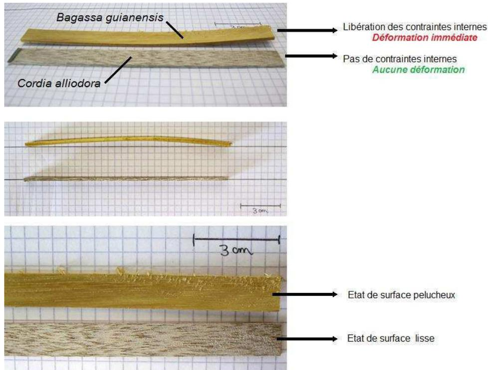
**Figure 148 : Effet du bois de tension sur la qualité de l'usinage des échantillons de module chez *B. guianensis*. Les échantillons de *C. alliodora* ne présentent ni flambement ni défaut de surface en comparaison à *B. guianensis*.**
