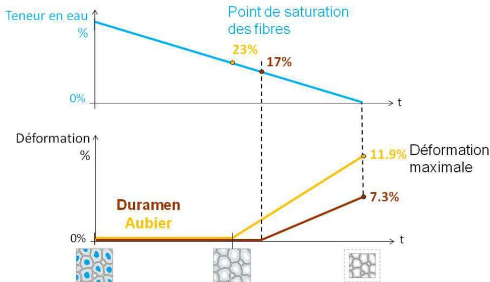
**Figure 143 : Trajectoires de séchage moyennes et observation du PSF selon le type de bois chez *B. guianensis*. La déformation exprimée en % est représentée pour les échantillons d'aubier (en jaune) et de duramen (en marron) selon la teneur en eau des échantillons. Les deux courbes correspondent à aux courbes moyennes calculées à partir des résultats obtenus pour l'ensemble des échantillons appartenant à chaque type de bois.**
