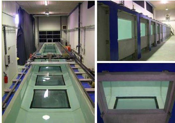
**FIGURE 4.9** – Bassin des carènes de l'Institut Pprime, Université de Poitiers. Vue dans l'axe du bassin (photo de gauche), sur le côté (photo en haut à droite), et de dessous (en bas à droite).
