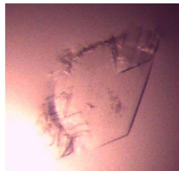
**Figure 53: Cristal de HU de *L.lactis*** obtenu dans la condition 47 du kit de cristallogénèse Sigma 1 (0,1M Acetate de sodium pH4,6 ; 2M Sulfate d'ammonium).
