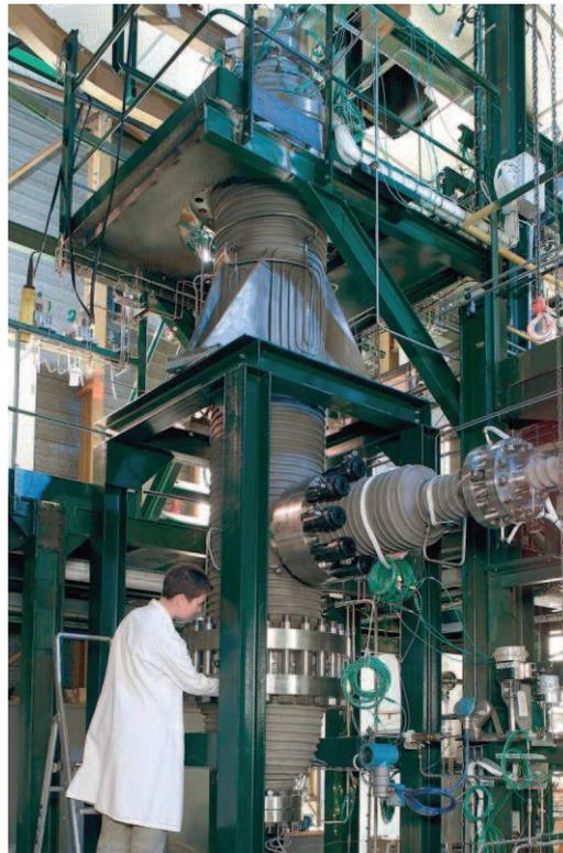
Figure 42. Photographie du réacteur LFHT (sans son calorifugeage)
