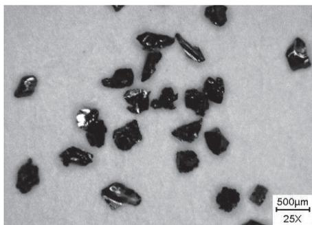
Figure 37. Grains de SiC observés à la loupe binoculaire
